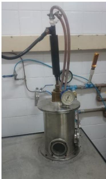
**Figura 19:** Forno a arco utilizado para preparar os precursores metálicos.
