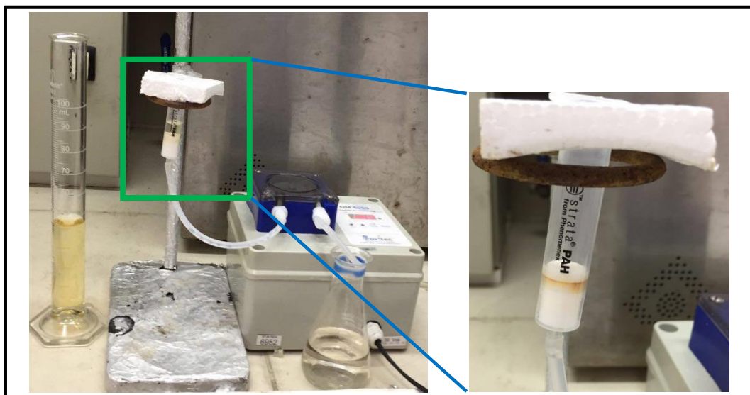
FIGURA 11- Esquema da extração, cartucho. Detalhe ampliado.
