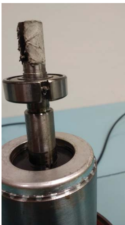
Figura 37 – Rolamento danificado trilha externa
