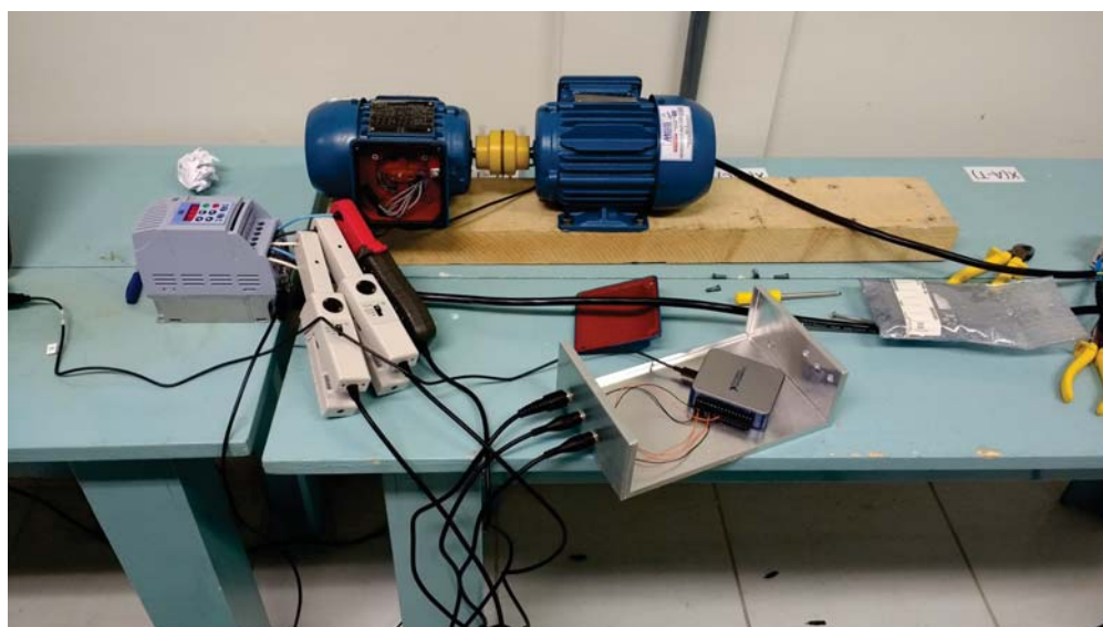
Figura 27 – Motores de indução montados para realização dos ensaios em bancada.
