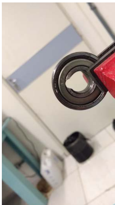
Figura 36 – Rolamento danificado trilha interna
