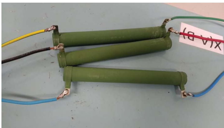
Figura 28 – Resistores de 100\ \Omega alimentados pelo motor de indução 2 funcionando como gerador assíncrono.
