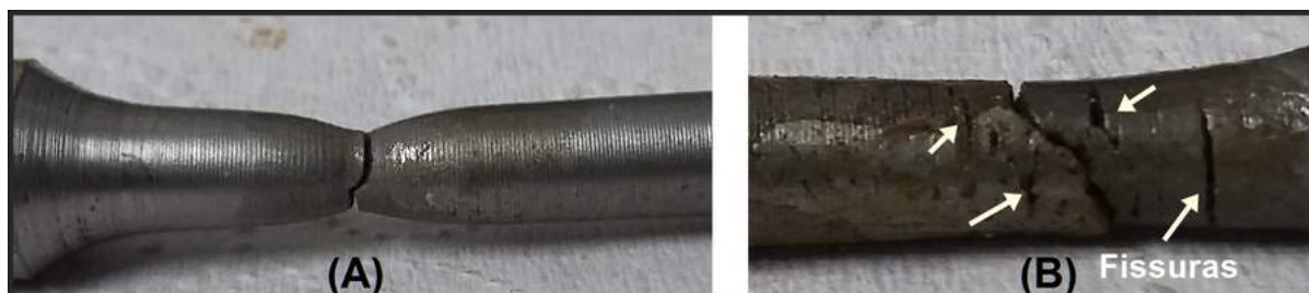
Figura 83 – Corpos de prova após ensaio BTD: (A) Sem hidrogenação e (B) Com hidrogenação.
