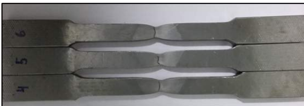
Figura 76 – Corpos de prova CT após o ensaio de tração.
