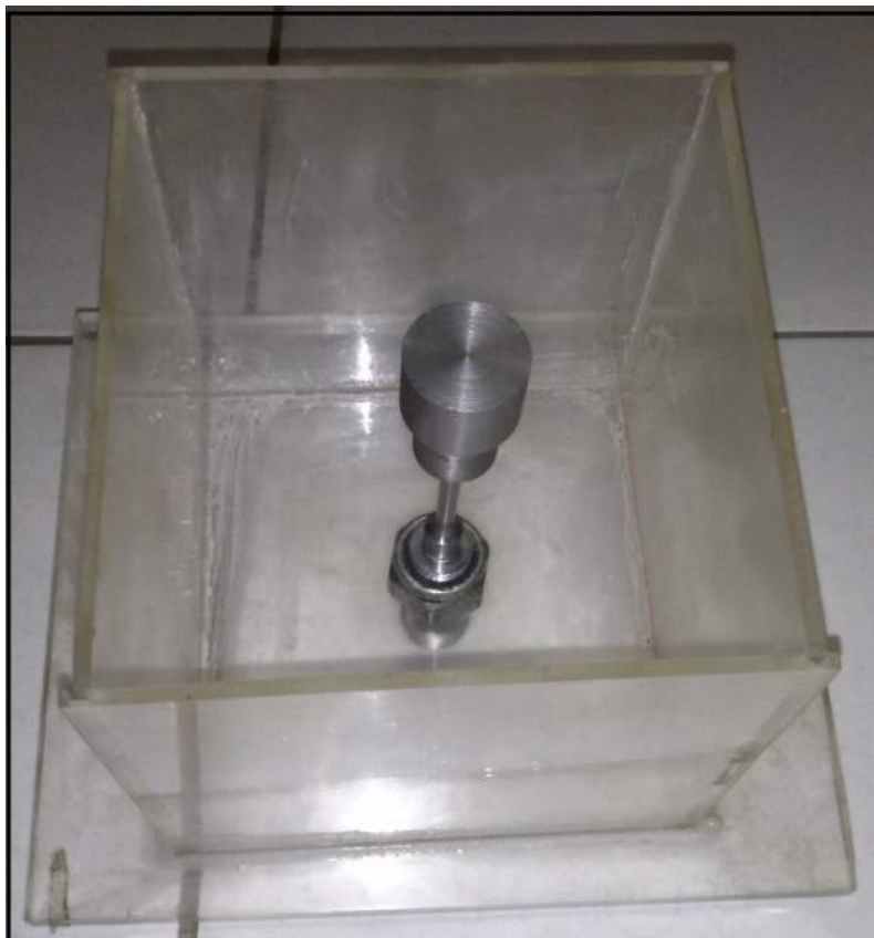
Figura 29 – Célula eletroquímica para realização de ensaio BTd.
