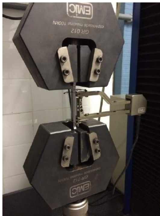
Figura 23 – Montagem de corpo de prova para ensaio de tração.
