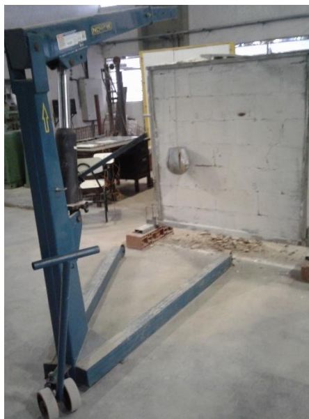
Foto 15 – Verificação da Estabilidade das Paredes Após Ensaio Térmico
