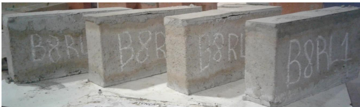
Foto 36 - Desagregação dos Blocos Após Ensaio Térmico 800 °C – 2
