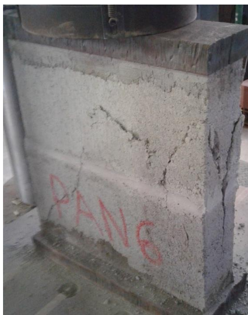
Foto 37 - Prisma Ensaiado à Resistência à Compressão Axial
