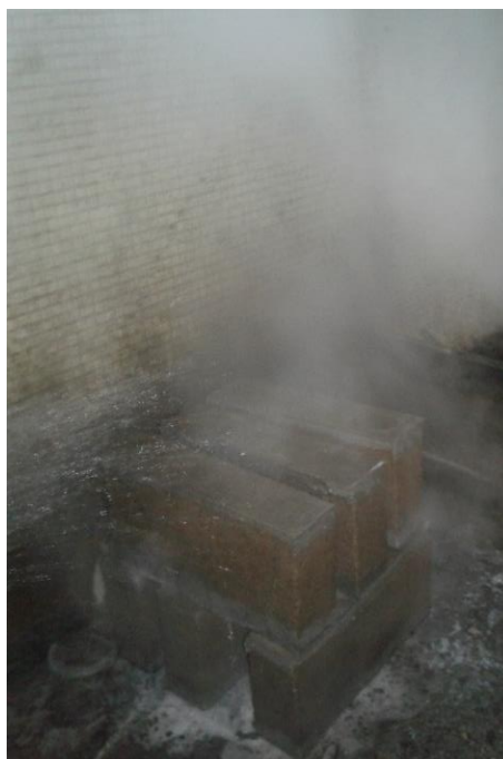
Foto 19 – Resfriamento Brusco dos Blocos por Jato de Água
