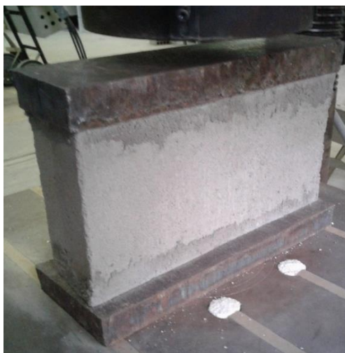
Foto 16 – Preparação do Bloco para Ensaio de Resistência à Compressão Axial
