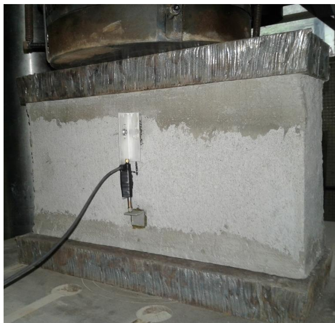
Foto 26 – Realização do Ensaio de Módulo de Elasticidade dos Blocos
