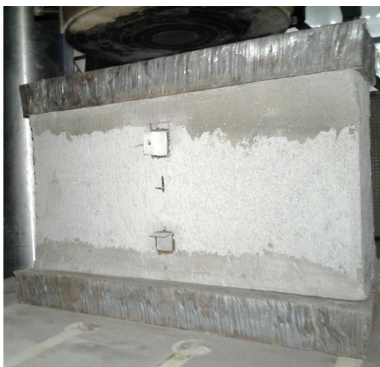
Foto 25 – Montagem para Realização do Ensaio de Módulo de Elasticidade Longitudinal dos Blocos
