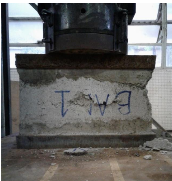
Foto 28 – Bloco Ensaiado à Resistência à Compressão Axial
