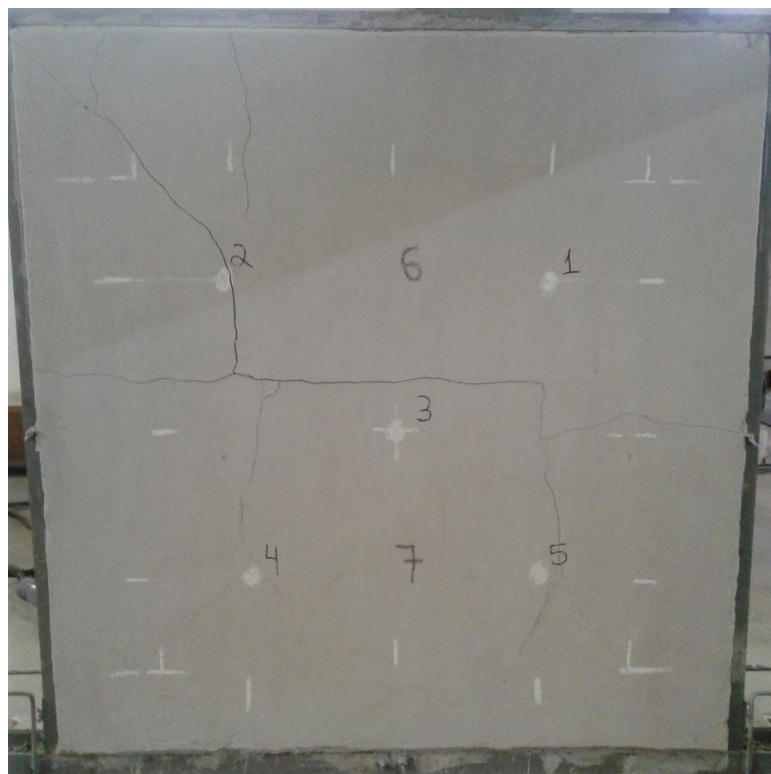
Foto 55 - Face Não Exposta ao Aquecimento da Parede 5 Após Ensaio Térmico e de Choque Mecânico
