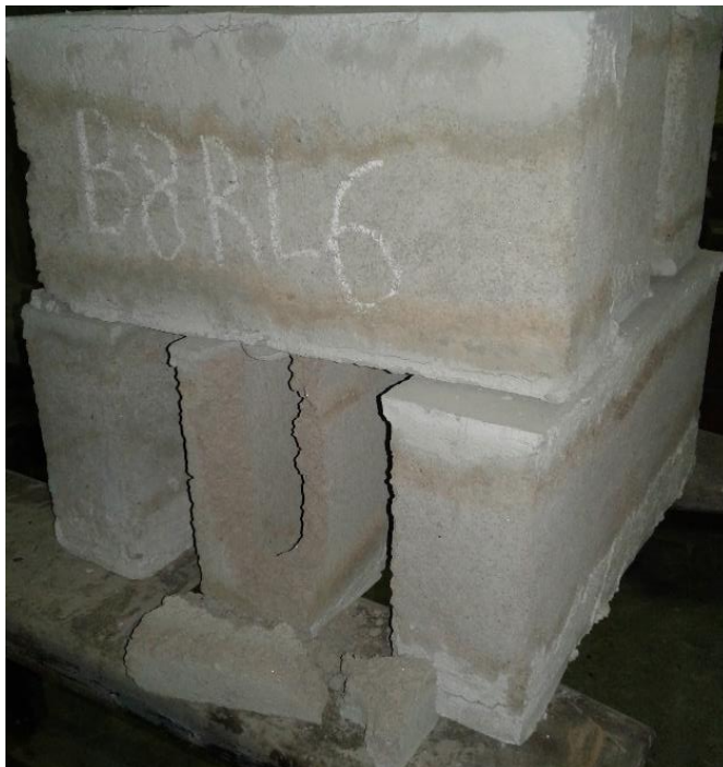
Foto 35 – Desagregação dos Blocos Após Ensaio Térmico 800 °C - 1
