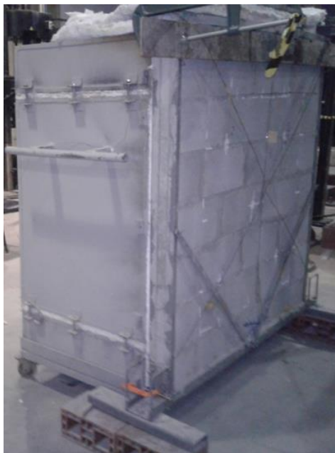
Foto 14 – Contato do Forno com a Parede Durante Ensaio Térmico
