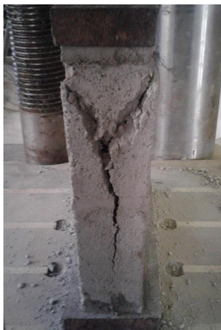
Foto 38 - Prisma Após Ensaio de Resistência à Compressão Axial
