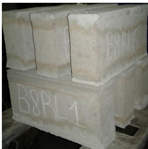
Foto 34 - Blocos Após Ensaio Térmico a 800 °C
