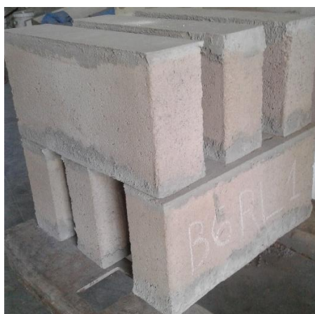
Foto 33 - Blocos Após Ensaio Térmico a 600 °C
