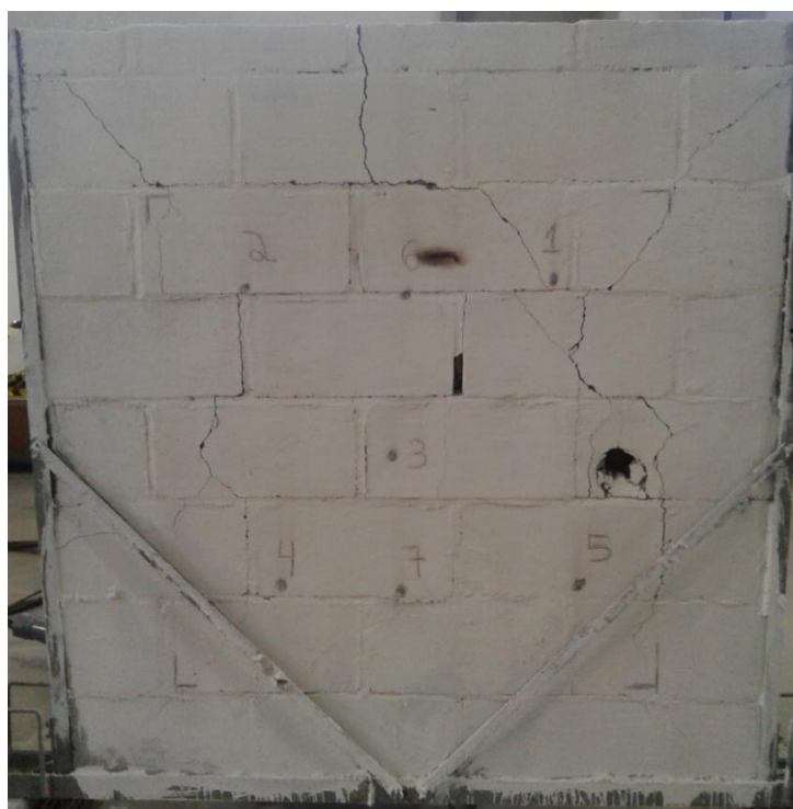
Foto 52 - Face Não Exposta ao Aquecimento da Parede 4 Após Ensaio Térmico e de Choque Mecânico
