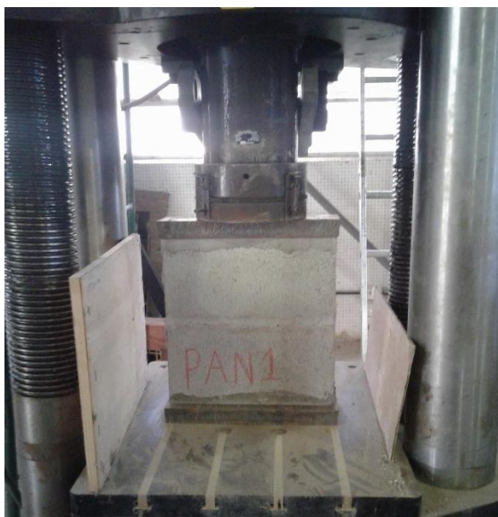
Foto 20 - Preparação do Prisma para Ensaio de Resistência à Compressão Axial
