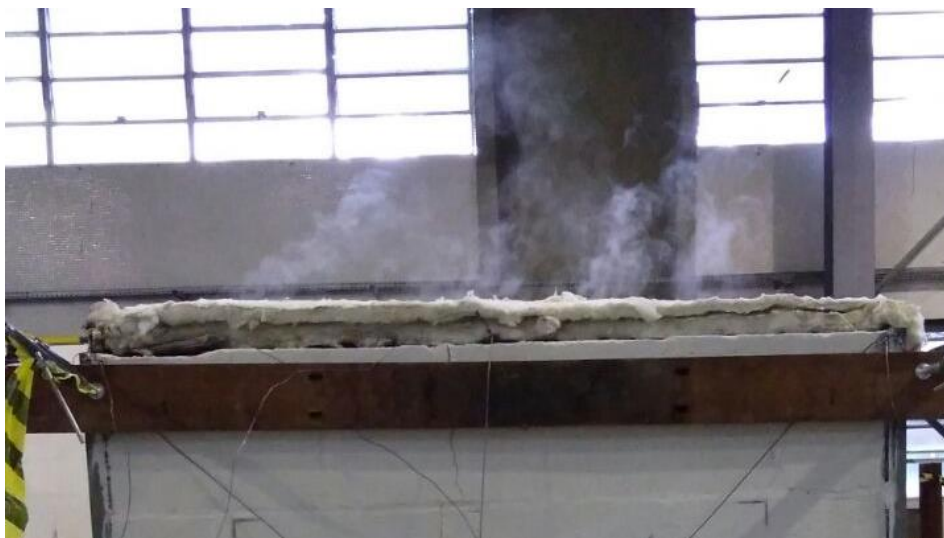
Foto 53 – Liberação de Vapor D'água Sob Pressão da Região Superior da Parede 4
