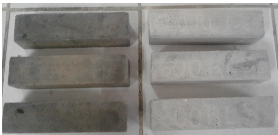
Foto 42 – Exemplares de Argamassa Ensaiaados Termicamente até 600 °C, Resfriados Bruscamente e Resfriados Lentamente
