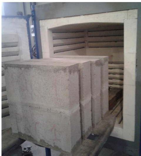
Foto 10 – Configuração para Ensaio Térmico dos Prismas
