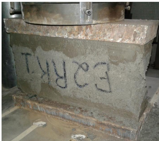
Foto 30 – Bloco Saturado Ensaiado à Resistência à Compressão Axial
