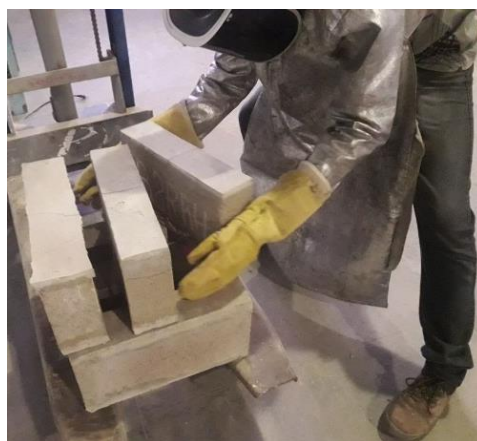
Foto 18 – Metodologia de Ensaio a Quente Blocos
