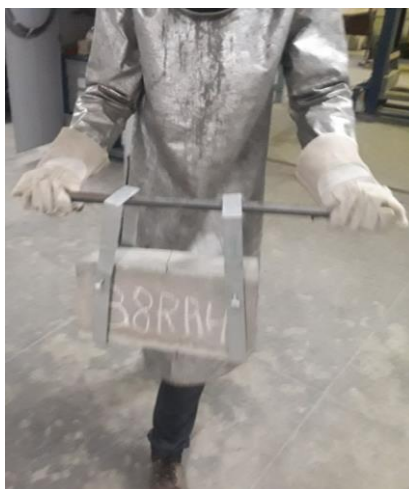
Foto 17 – Metodologia de Ensaio a Quente Blocos
