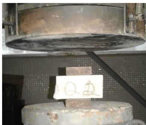
Foto 23 - Ensaio de Resistência à Compressão das Argamassas
