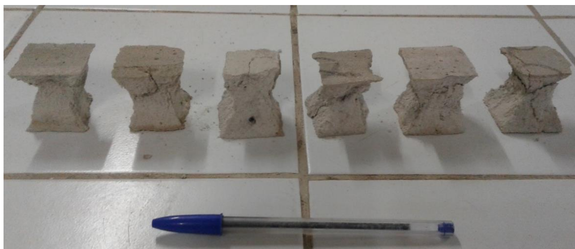
Foto 41 - Argamassa Após Ensaio de Resistência à Compressão
