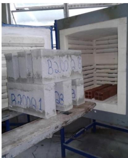
Foto 8 – Configuração para Ensaio Térmico dos Blocos
