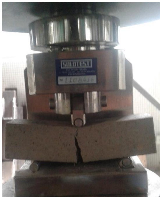
Foto 39 – Argamassa Ensaaiada à Tração na Flexão
