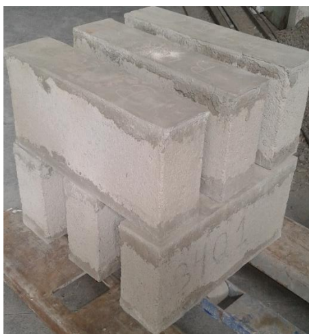
Foto 32 – Blocos Após Ensaio Térmico a 400 °C
