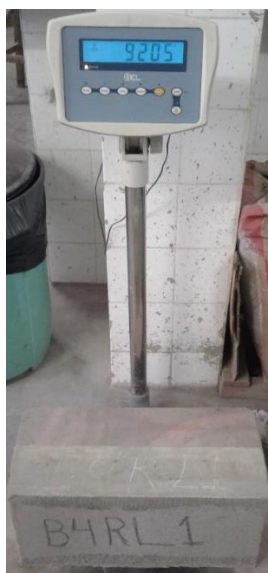
Foto 6 – Pesagem dos Blocos
