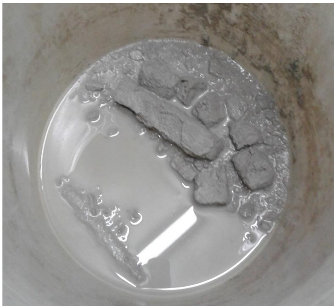
Foto 44 - Exemplar de Argamassa Desagregado Após Ensaio Térmico à 800 °C e Resfriamento Brusco por Submersão em Água
