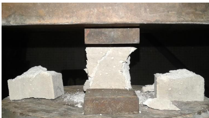
Foto 40 - Argamassa Ensaaiada à Compressão
