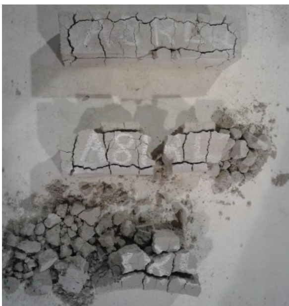
Foto 43 – Exemplar de Argamassa Desagregado Após Ensaio Térmico à 800 °C e Resfriamento Lento
