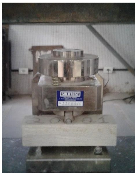
Foto 22 – Ensaio de Resistência à Tração na Flexão das Argamassas
