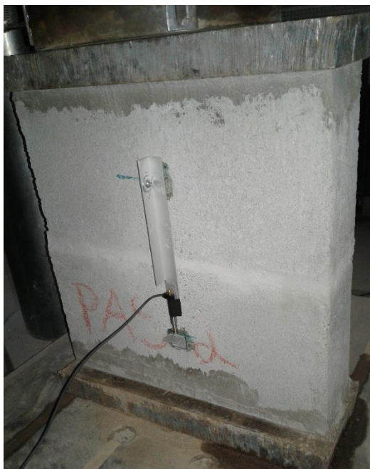
Foto 27 – Realização do Ensaio de Módulo de Elasticidade dos Prismas
