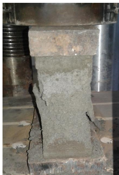
Foto 31 – Bloco Saturado Após Ensaio de Resistência à Compressão Axial
