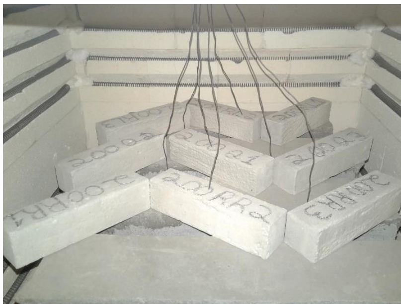
Foto 11 – Configuração para Ensaio Térmico das Argamassas
