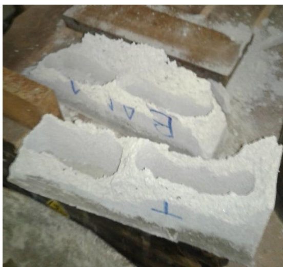
Foto 29 – Bloco Após Ensaio de Resistência à Compressão Axial
