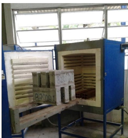
Foto 1 – Forno Menor (Utilizado para Blocos e Prismas)
