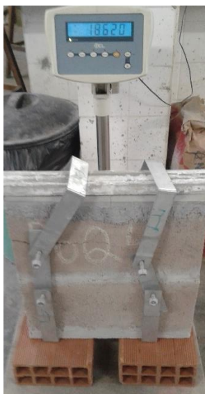
Foto 21 - Metodologia de Ensaio a Quente Prismas
