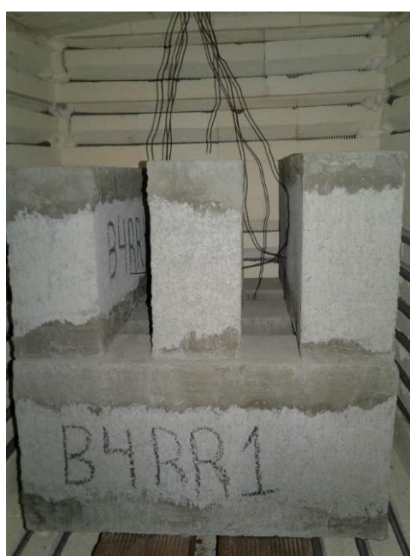
Foto 9 – Configuração dos Blocos com os Termopares
