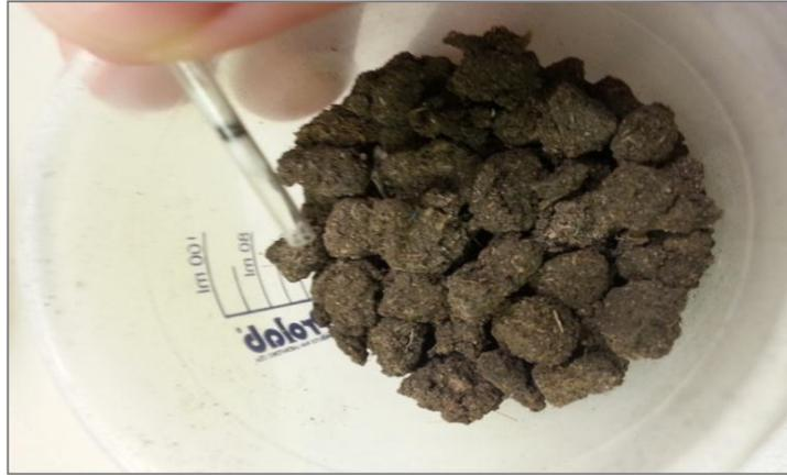
**Figura 31.** Comparação entre o tamanho do tubo de quartzo usado nas pirólises e parte do lodo bruto seco.
