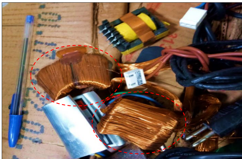
Figura 11 – Metal cobre retirado de Tubo de Raio Catódico (CRT) no galpão O Verde é a Nossa Vida
