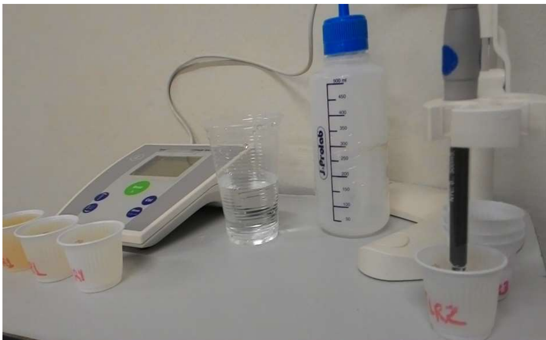
Fotografia 9- Leitura da Condutividade elétrica e pH nas soluções lixiviadas
