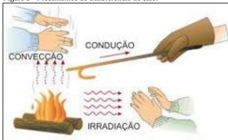
Figura 3 - Mecanismos de transferência de calor
