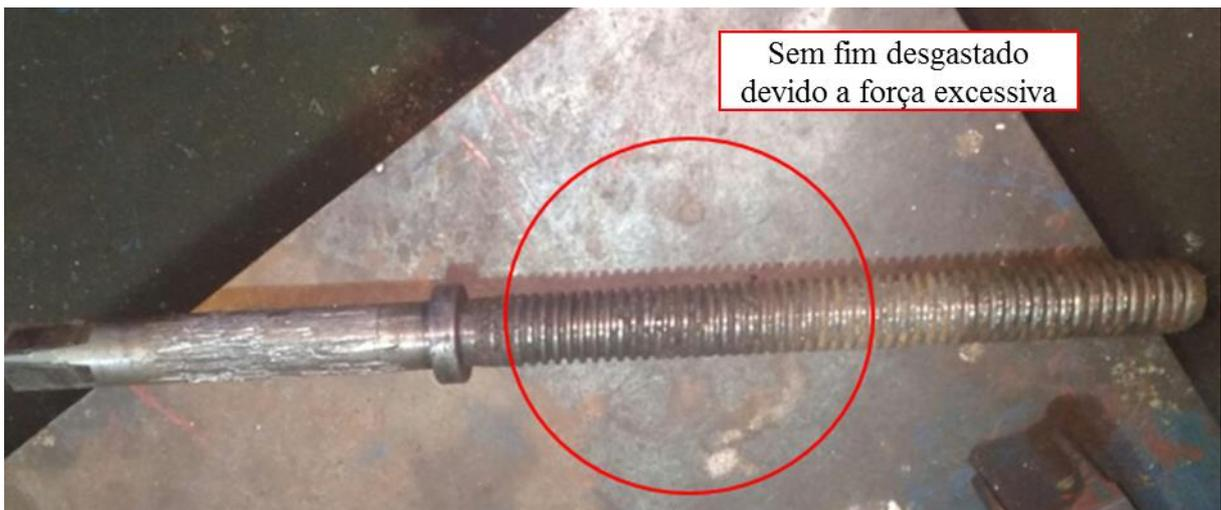
Figura 10 – Parafuso rosca sem fim danificado devido ao excesso de força empregado para fechamento da válvula.
