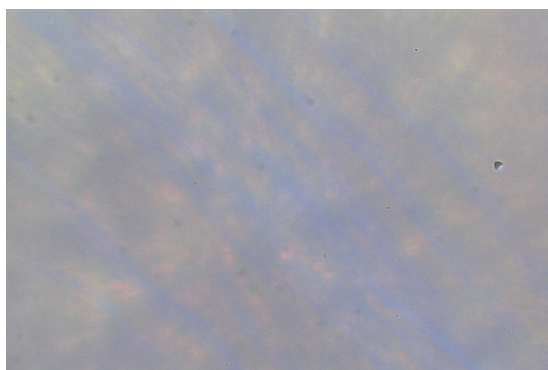
Figura 25. Fotomicrografia obtida a temperatura de 25°C utilizando microscopia de luz polarizada da formulação NE-DDA F10, objetiva de 32, mostrando gel isotrópico
