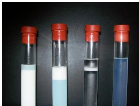
Figura 19. Representação da classificação de Winsor, representados respectivamente da esquerda para a direita por Winsor I, Winsor II, Winsor III e Winsor IV.
