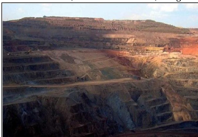
Figura 1 - Método de lavra a céu aberto, Mina Casa de Pedra, Congonhas (MG)
