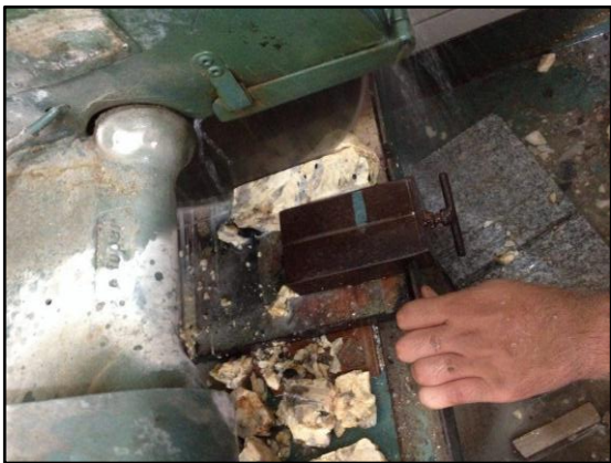
Figura 26 - Corte das amostras coletadas em campo com equipamento manual de disco diamantado.
