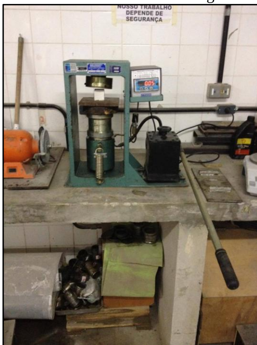
Figura 28 - Prensa hidráulica manual utilizada nos ensaios geomecânicos.
