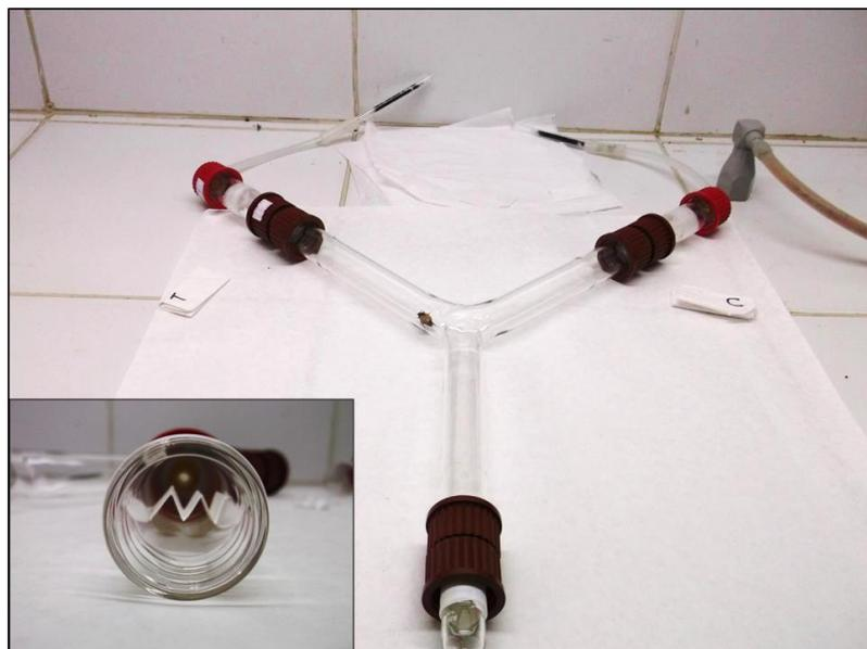
**Figura 4.3:** Teste de olfatômetro em tubo em Y. Em detalhe, é mostrado o posicionamento do papel de filtro contendo o estímulo dentro do tubo. (Fotos: G.K.N. Santos)
