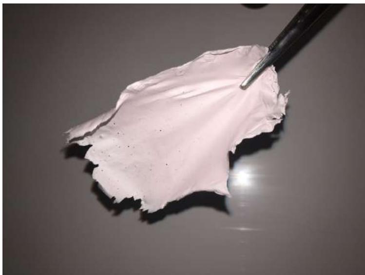
*Figura 128: Fotografia das nanofibras de Au\_NP/YVO<sub>4</sub>:Yb,Er@PVA\_NF obtidas através do método de eletrofiação.*
