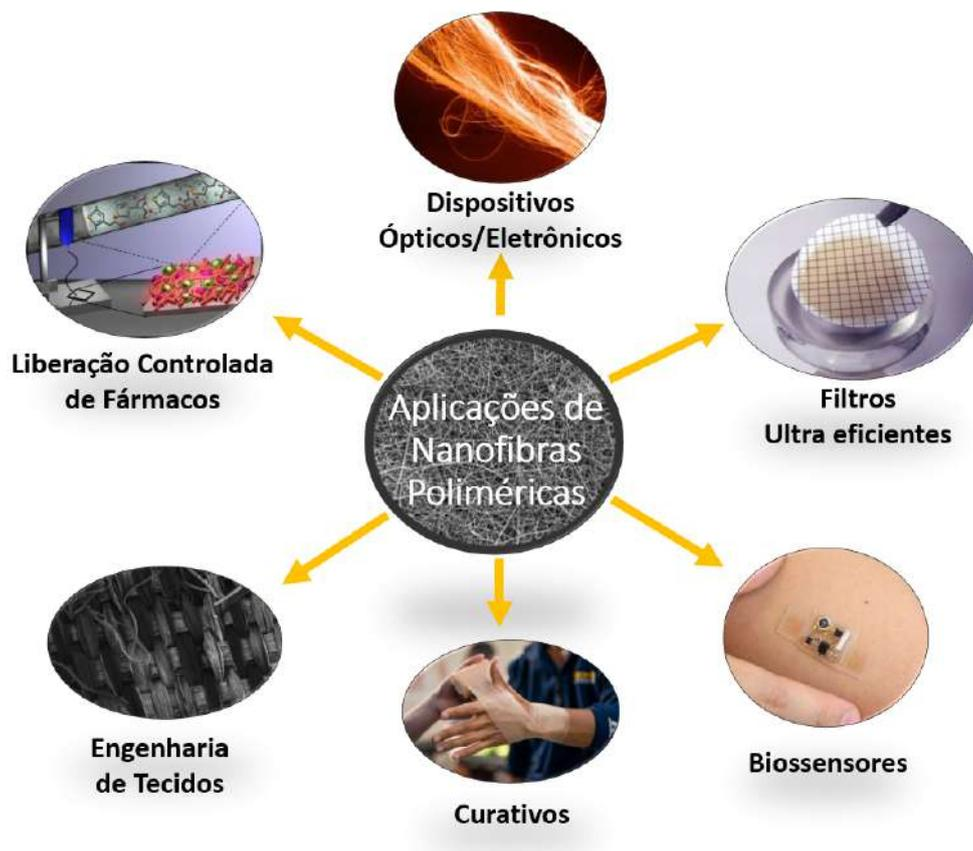
*Figura 76: Esquema mostrando as possibilidades de aplicações das nanofibras poliméricas obtidas através da técnica de electrospinning. Fonte: próprio autor.*
