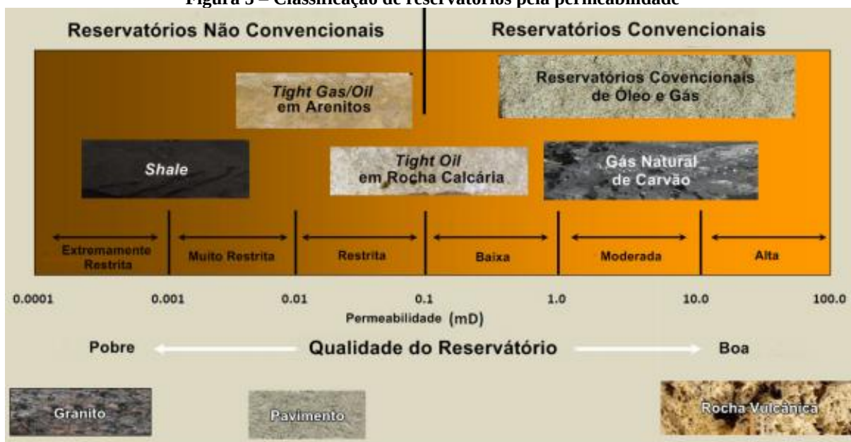
Figura 5 – Classificação de reservatórios pela permeabilidade
