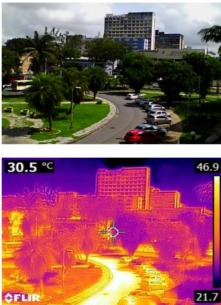
Imagem 21: Fotos térmicas mostram pavimentos (asfalto) e superfícies quentes em cor amarela, os revestimentos reflexivos e as áreas mais frescas (vegetação) em cor azul e púrpura
