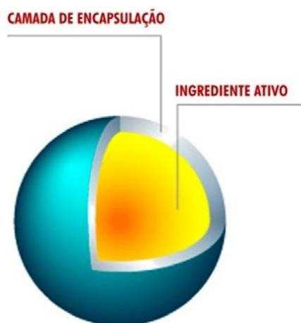
**Figura 5:** Microcápsula: o agente ativo envolvido pelo agente encapsulante
