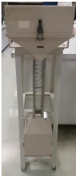
**Figura 21** - Medidor de Volume de Pão.
