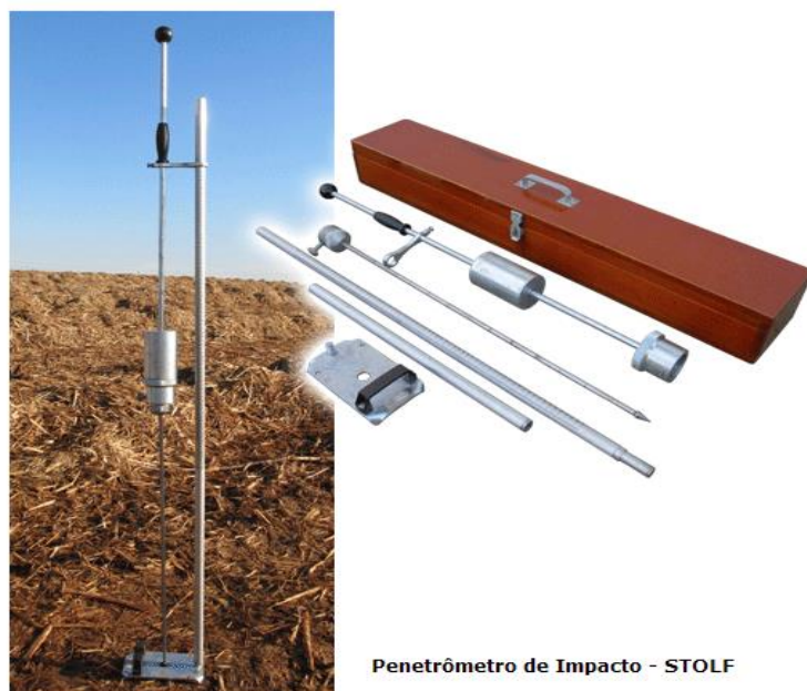
Figura 3.11 – Penetrômetro Dinâmico – Equipamento composto de uma haste com base para alinhamento e haste de com peso para penetração do cone no solo.
