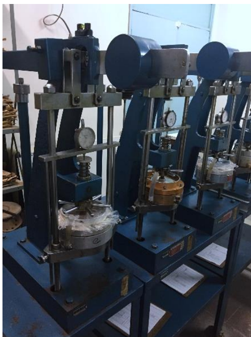
Figura 3.15 – Célula utilizada para ensaios edométricos.
