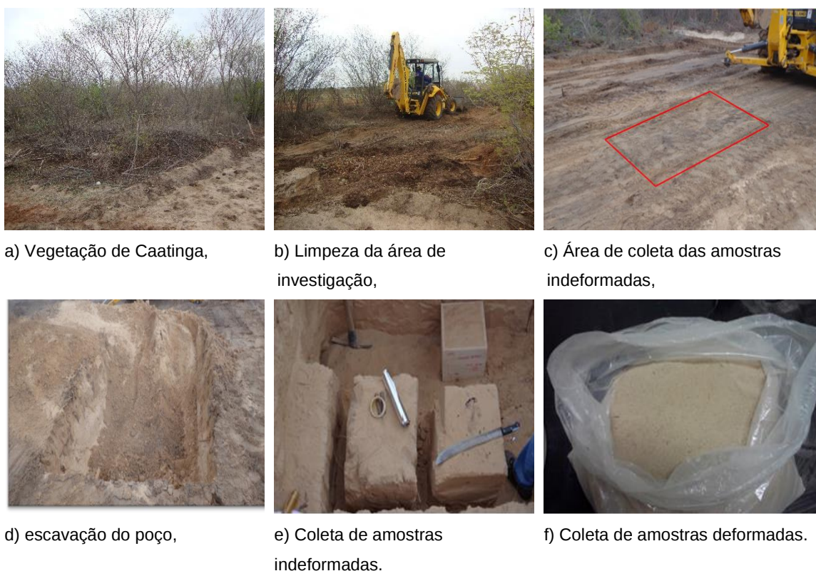
Figura 3.5 – Preparação da área e coleta amostras de solo.
