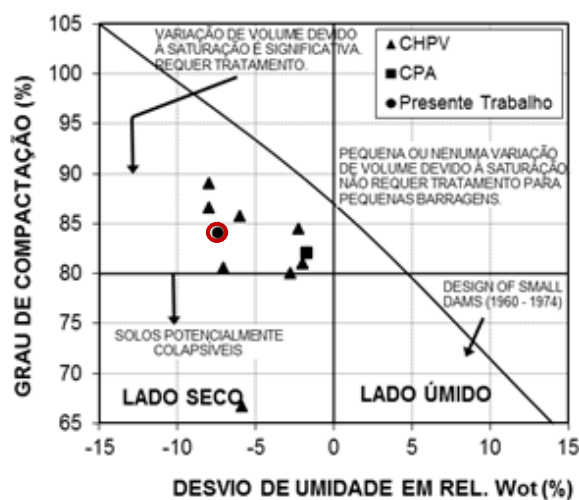
Figura 4.2 – Critério de colapsibilidade de Design of Small (1960-1974).
