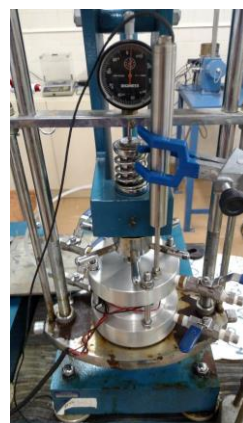
Figura 3.19 – Prensa edométrica: momento do ensaio devidamente instrumentado pelo computador e por defletores.
