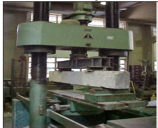
Figura 36 - Prensa usada para os ensaios de flexão de vigas
