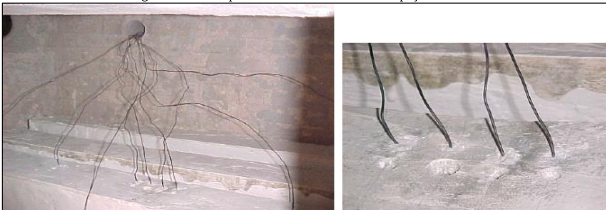
Figura 41 - Termopares localizados no interior da peça estrutural
