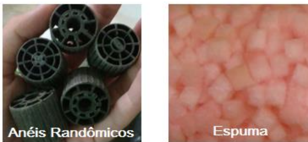
Figura 6 – Fotografia dos materiais usados para imobilização da biomassa: (a) anéis randômicos de polipropileno e (b) cubos de espuma de poliuretano
