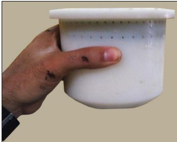
**Figura 20:** Vista lateral da cesta cilíndrico cônica mostrando os orifícios por onde entra a água de fluidização.
