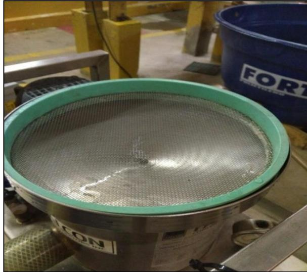
**Figura 19:** Vista por cima do Falcon mostrando por onde o material passa.
