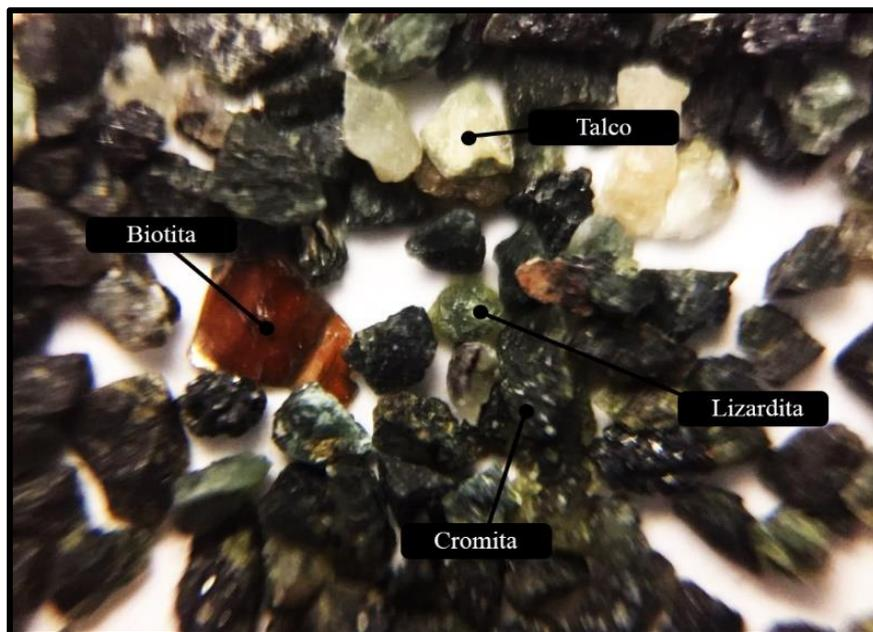
**Figura 27:** Análise microscópica na fração entre 18 malhas (1.000  $\mu\text{m}$ ) e 20 malhas (830  $\mu\text{m}$ ).
