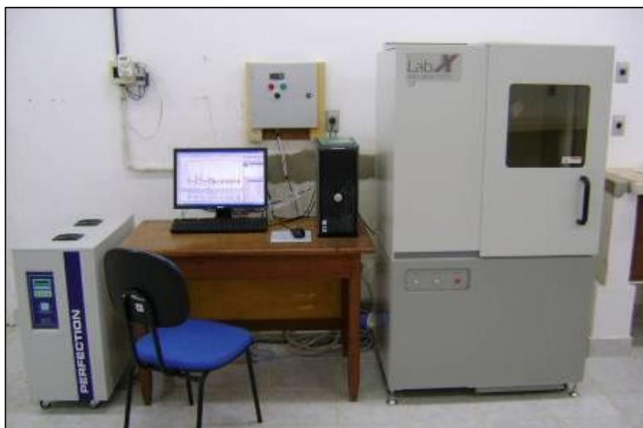
**Figura 16:** Difratômetro Shimadzu XRD-6000.
