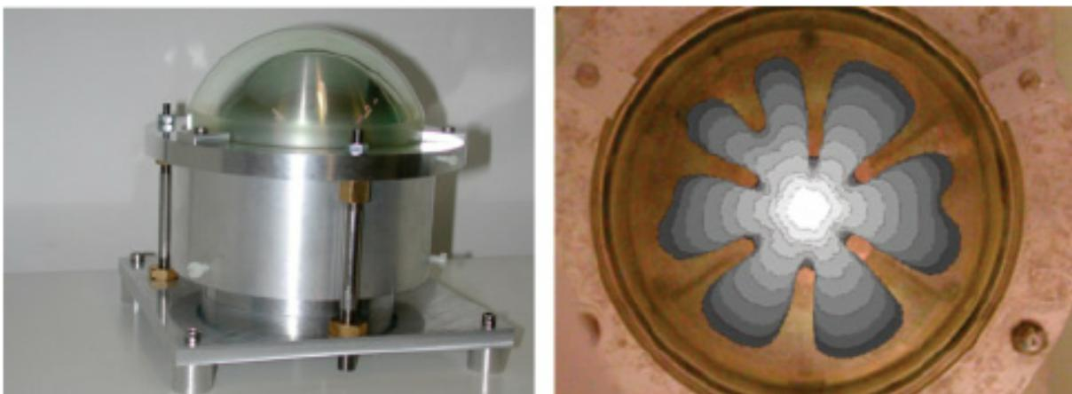
Figura 8 – Na esquerda, célula de Hele-Shaw no formato de um hemisfério esférico. Na direita, exemplo de interface perturbada obtida na célula de Hele-Shaw esférica. As propriedades morfológicas, como aparecimento de tip-splitting, são bem similares às vistas na Fig. 5(b). Imagem retirada de [22].
