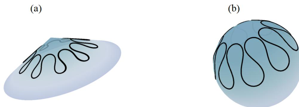
Figura 23 – Soluções estacionárias para o caso de (a) cone e (b) esfera. Nesta figura o eixo de rotação coincide com o eixo de simetria das superfícies. Temos que o forma dos padrões gerados tem características similares aos do caso plano. A interface obtida na esfera também é bastante similar a aquela para caso elástico, que está ilustrada na Fig. 21.
