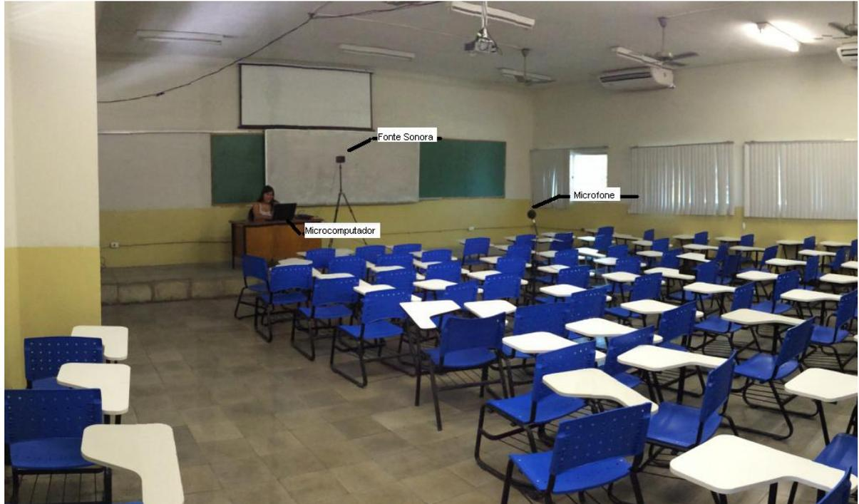
Figura 32-Sistema de medição com microfone (receptor), fonte sonora e computador com software Dirac.
