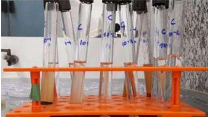
Cinco réplicas foram preparadas para cada diluição. Em seguida, as amostras diluídas foram colocadas em placas de Petri contendo meio de cultura Nitrate mineral salts medium (NMS), detalhado no anexo II, Figura 15.
