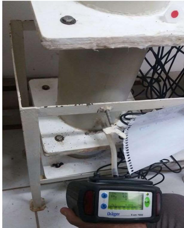
Para a coleta dos gases no topo das colunas foi fixada uma tampa, a qual está acoplada uma válvula esfera ( $\varnothing = 6 \text{ mm}$ ); esta tinha como finalidade o encaixe do equipamento X-am 7000 para medição, Figura 23.
