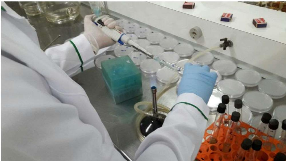
Após o espalhamento das diluições do solo, as placas permaneceram em repouso durante 2h; isso foi feito para melhor absorção das amostras pelo meio de cultura. As placas foram colocadas em dessecadores para incubação em estufa a 30 °C, Figura 16.
