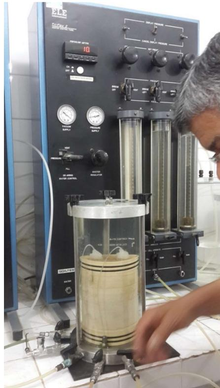
O corpo de prova possuía dimensões de 12,7cm de altura e 10,0cm de diâmetro. O procedimento do ensaio é descrito a seguir:
