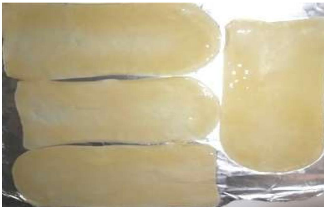
**Figura 14:** Membrana úmida produzida a partir do meio Hestrin-Schram modificado.
