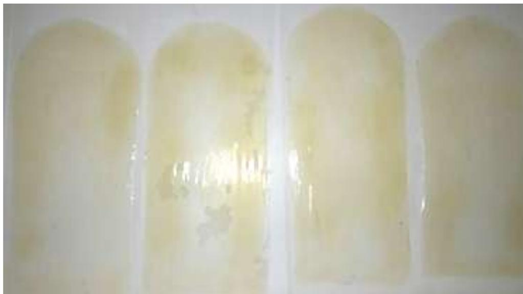
**Figura 15:** Membranas secas produzidas a partir do meio Hestrin-Schram modificado.
