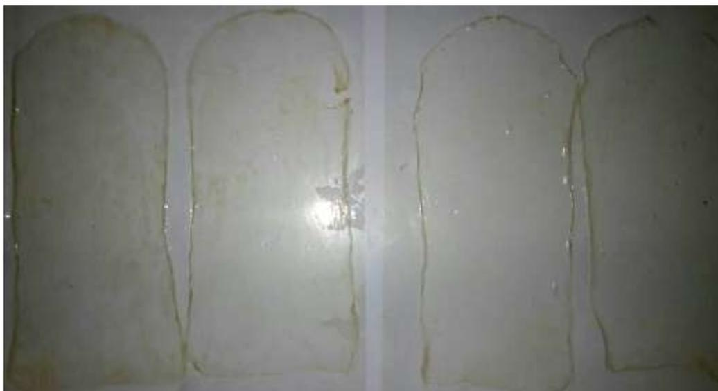
**Figura 13:** Membranas secas produzidas a partir do meio salino.
