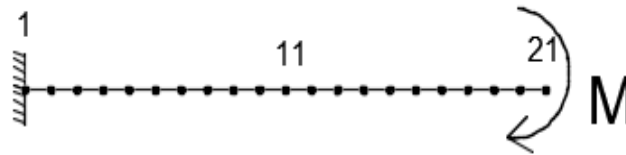
Figura 5.12 – Discretização da malha para viga engastada com momento.
