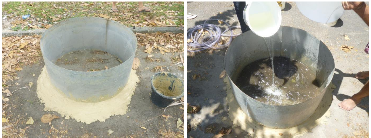
a) Fixação do infiltrômetro com bentonita b) Adição do volume constante de água
