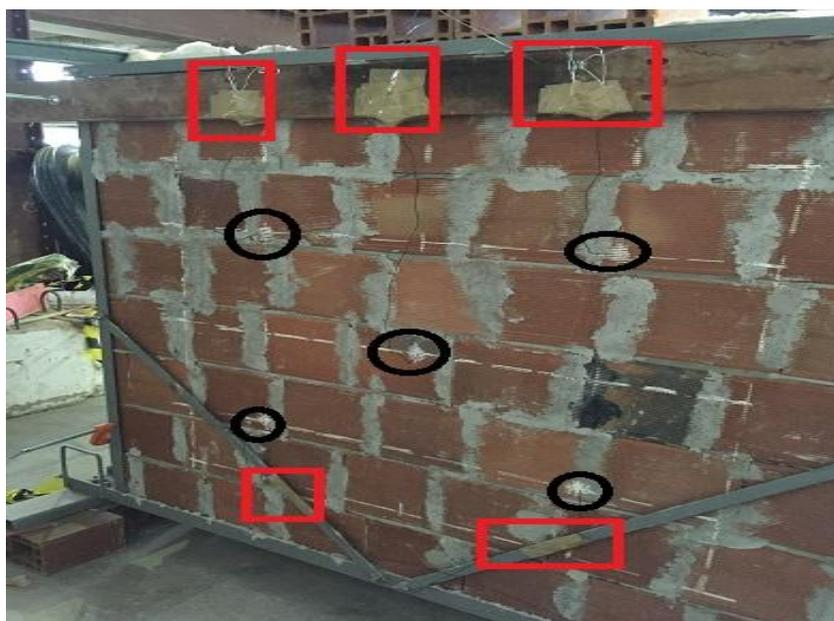
**Figura 51- Fixação dos termopares externos, na parte superior e inferior, da face exposta ao fogo.**
