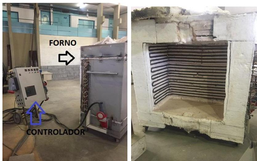
Figura 30- Forno elétrico, utilizado para ensaios de pequenas paredes.
