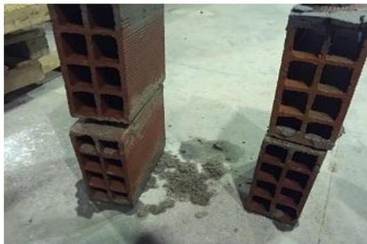
**Figura 40- Prisma após sofrer resfriamento brusco**
