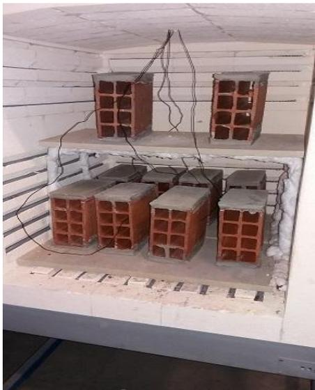
**Figura 33- Distribuição dos blocos no forno**
