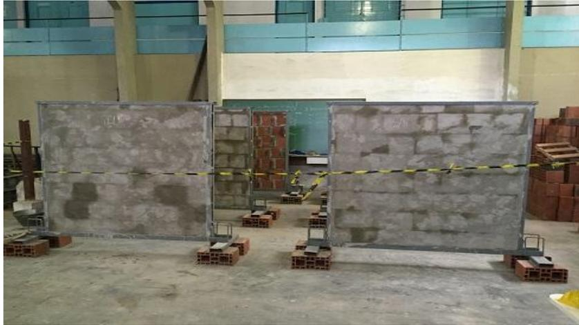
**Figura 49- Finalização da construção das alvenarias, aguardando os 28 dias cura.**
