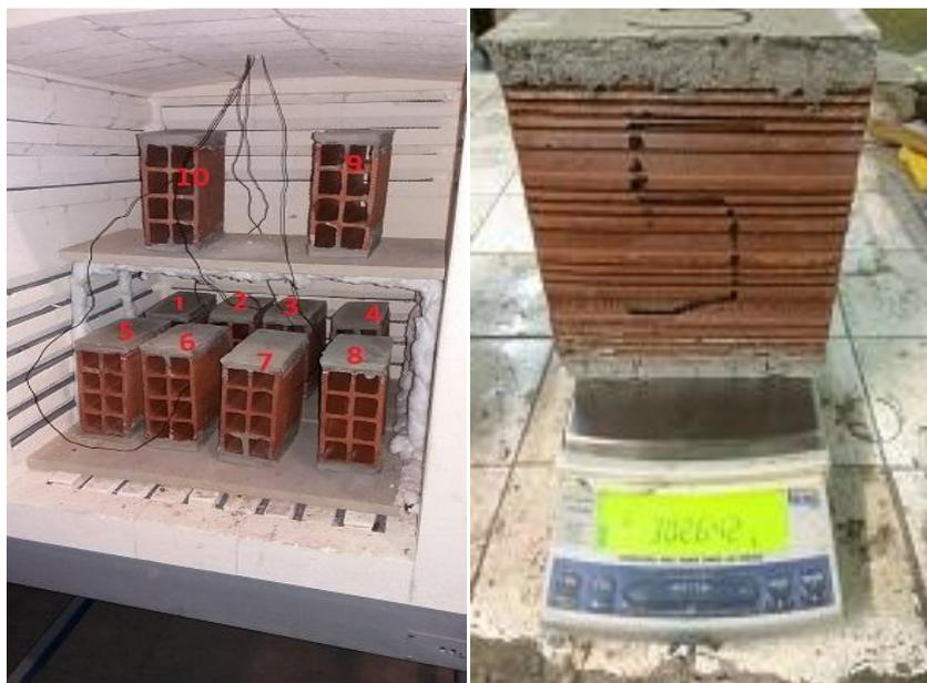
**Figura 35- Numeração dos blocos e pesagem dos blocos.**
