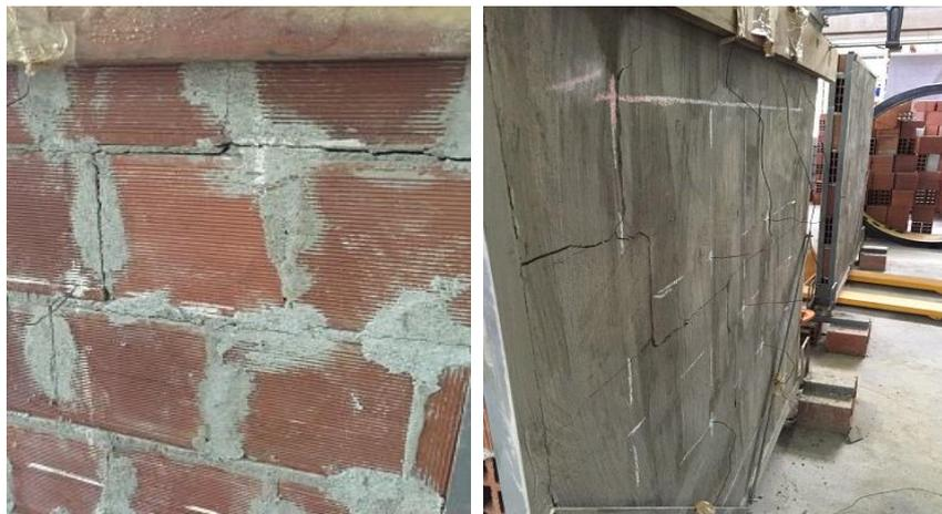
**Figura 52- Primeiras fissuras apareciam em média após 15 minutos de aquecimento.**
