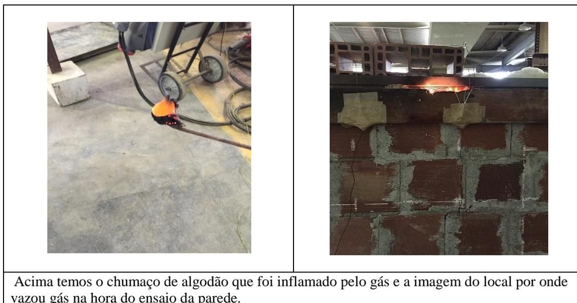
**Figura 55- Parede 3, durante o ensaio.**
