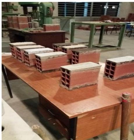
**Figura 34- Blocos após capeamento esperando para serem ensaiados**
