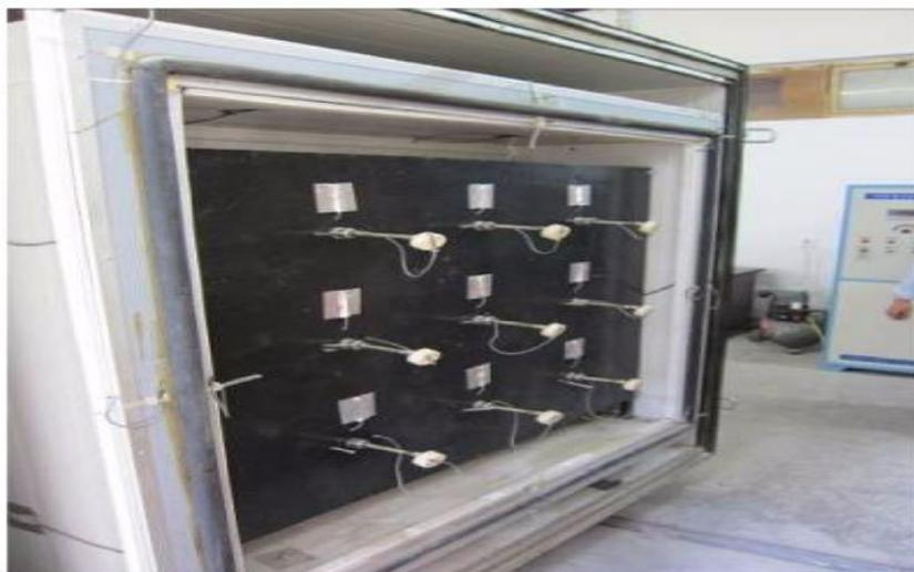
**Figura 13- Posição dos termopares nas paredes ensaiadas por Wu (2014)**
