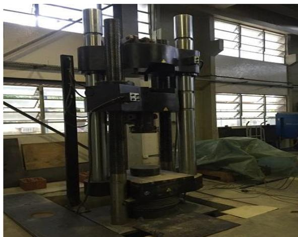
**Figura 26: Prensa Hidráulica, ensaios a compressão.**
