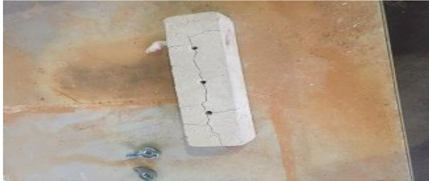
**Figura 46- Corpo de prova, utilizado para medir as temperaturas do forno.**
