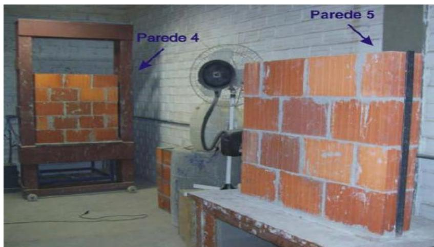
Figura 10- Modelo de pequenas paredes, utilizado nos ensaios de Rigão (2012).
