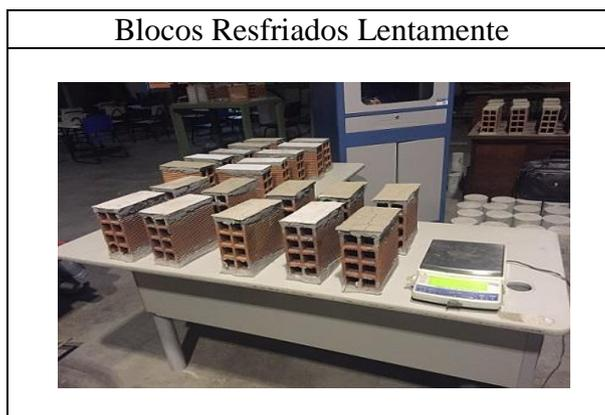
**Figura 43- Blocos e Prismas resfriando em temperatura ambiente após aquecimento.**
