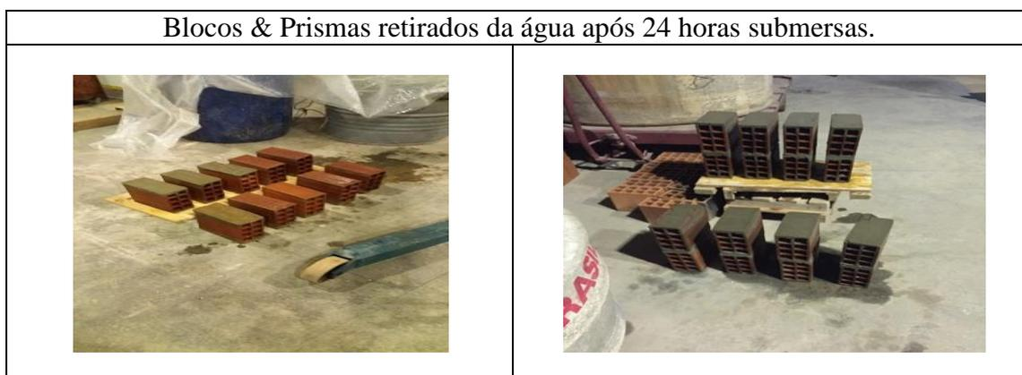
**Figura 39- Blocos e Prismas retirados de água após 24 horas submersas.**
