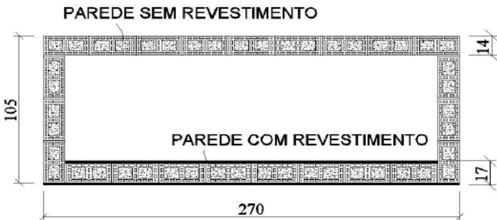
**Figura 6-** Layout do compartimento em paredes com e sem revestimentos e ambos com preenchimento, Rosemann (2011).
