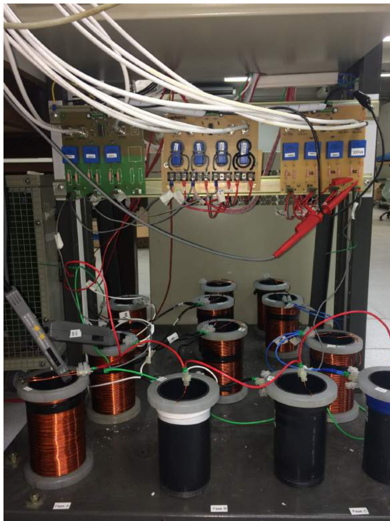
Figura 90 – Detalhe Inferior do quadro vertical apresentado na Figura 88. Na parte superior da esquerda para direita são mostradas as placas de aquisição dos sinais de: tensões na carga v_o ; Correntes na carga i_o e da fonte de corrente c.c.; Tensões nos capacitores da malha semi-Z v_c . Na parte de baixo são vistos os indutores utilizados para as duas topologias
