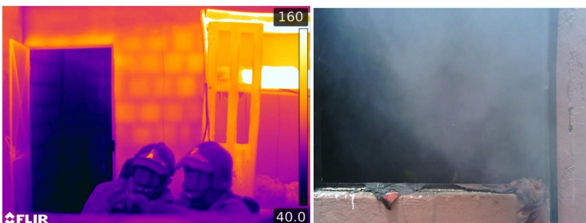
Nas imagens térmicas pode ser visto uma grande quantidade de informações as quais podem otimizar o combate a incêndios, como peças com grande liberação térmica (focos de incêndio) que ficam invisíveis em meio aos gases
