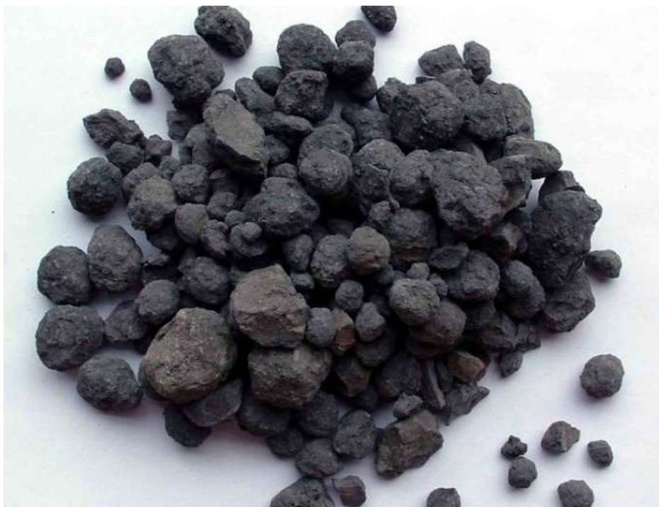
Figura 4 - Clínquer produzido pela Fábrica de Cimentos Intercement, em São Miguel dos Campos – AL (Branção, 2011).
