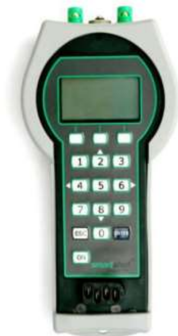
Figura 27 - Exemplo de dispositivo usado para digitar os tempos de retardo de cada espoleta do sistema eletrônico de disparo (Manual Smartshot, 2008).
