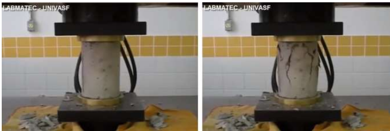
Figura 5 - Ensaio de resistência a compressão em corpos de prova (LABMATEC – UNIVASF, 2016).
