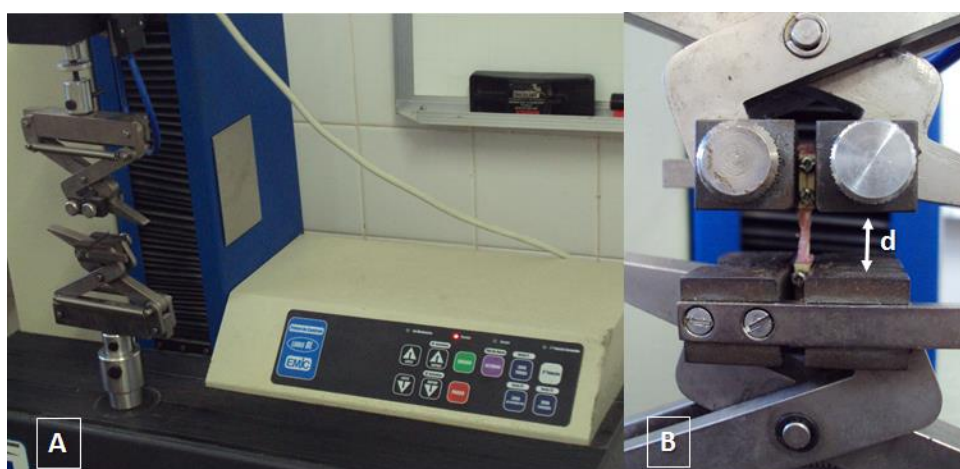
Figura 8. Ensaio mecânico do tendão do calcâneo da pata esquerda. Acoplamento do tendão as garras de pressão (A) e máquina de ensaio mecânico da marca EMIC® (B) (Fonte: arquivo pessoal do autor).
