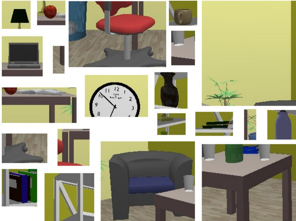
Figura 4.3 – Exemplos de regiões segmentadas pelo algoritmo StochGrow. Note que, ao mesmo tempo em que vários objetos foram segmentados de forma satisfatória (livros, xícara, vaso, poltrona, garrafa térmica, relógio, lapto, maçã, abajur), vários falsos positivos foram obtidos (parte da cadeira, partes das mesas, parte da estante, parte da parede). Como StochGrow se baseia na semelhança entre regiões, objetos complexos e texturizados dificilmente são segmentados corretamente.
