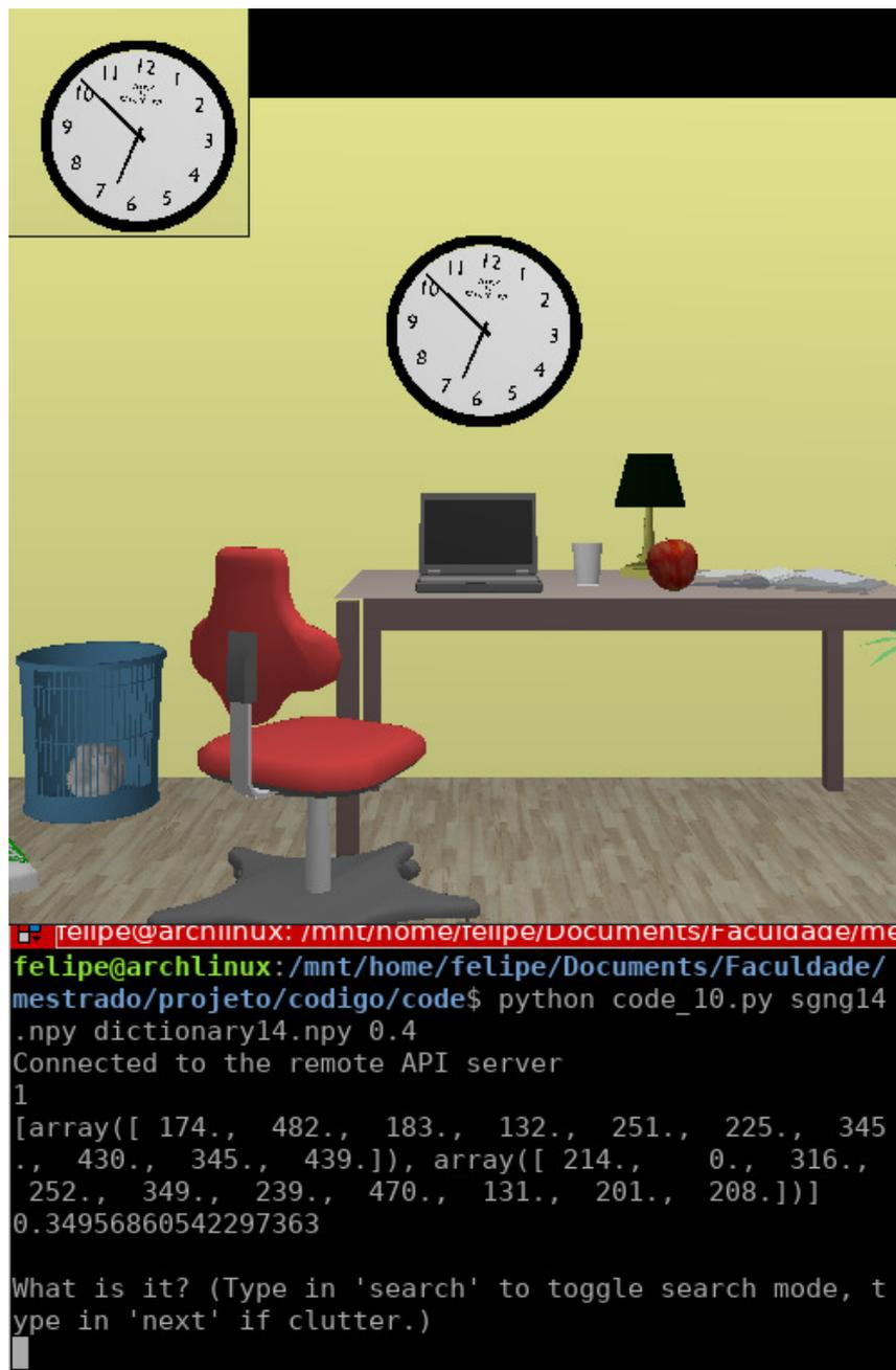
Figura 4.4 – Interface de interação com operador humano. No canto superior esquerdo está a imagem segmentada por *StochGrow* à qual se refere a pergunta “o que é isto?”.
