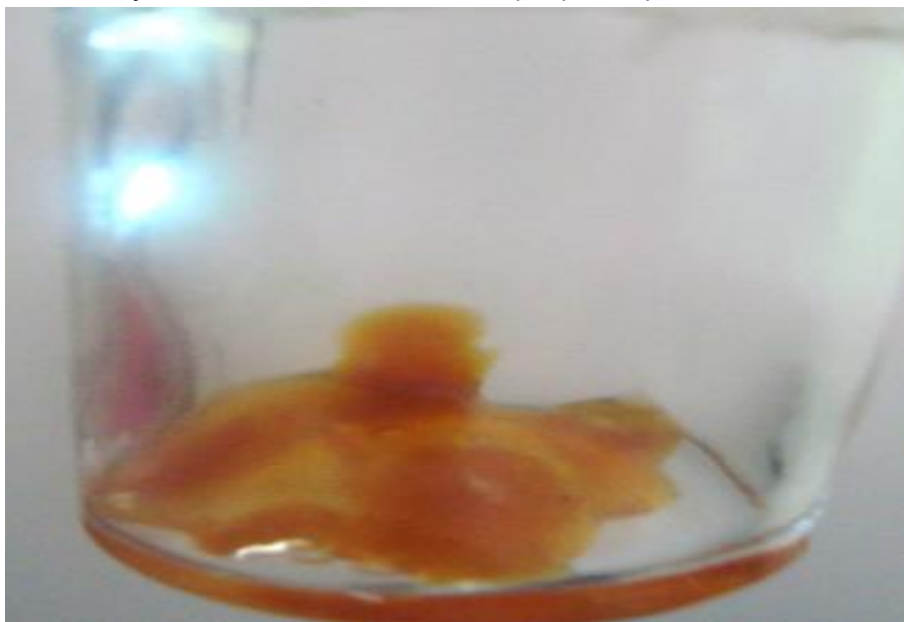
Figura 15 - Aspecto macroscópico do produto formado utilizando uma concentração de maltodextrina de 8,75 % (m/v) e temperatura de 59,3 °C.
