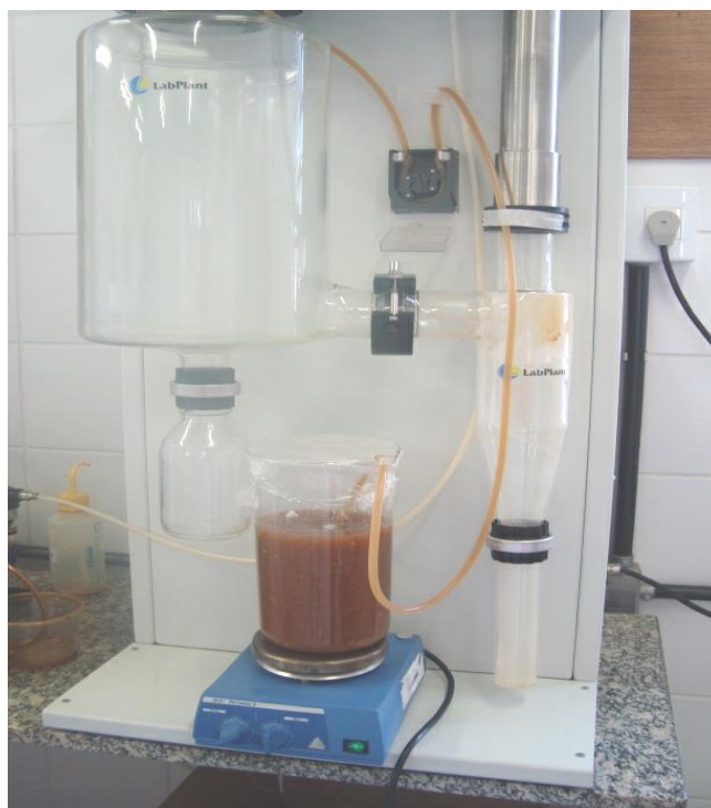
Figura 5 - Foto do secador Mini Spray Dryer (SD-Basic).
