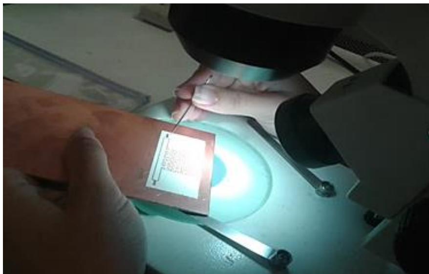
Figura 6.6: Retirada de resíduos de cobre e de substrato do interferômetro 4 com auxílio de um microscópio.
