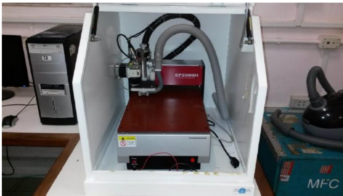
Figura 6.5: Máquina de prototipagem utilizada na fabricação dos dispositivos.
