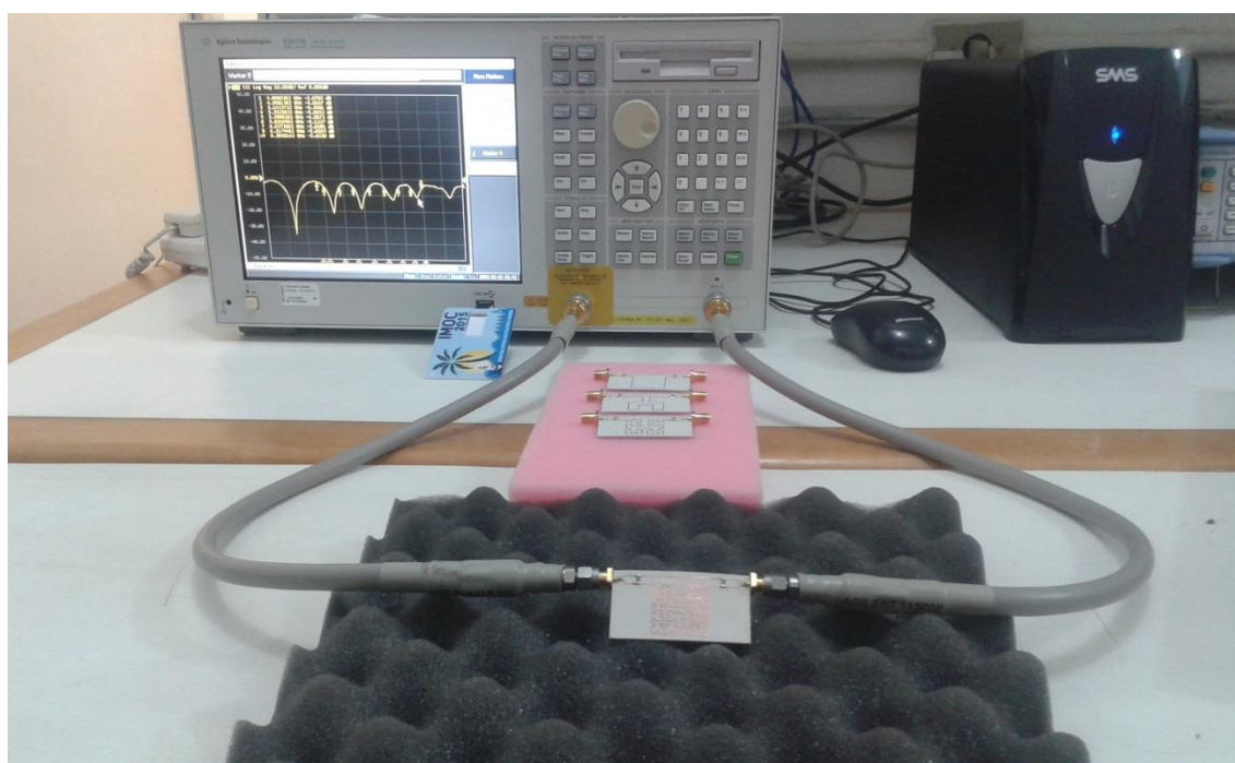
Figura 6.8: Medição experimental do interferômetro 4 utilizando o analisador de redes vetorial.
