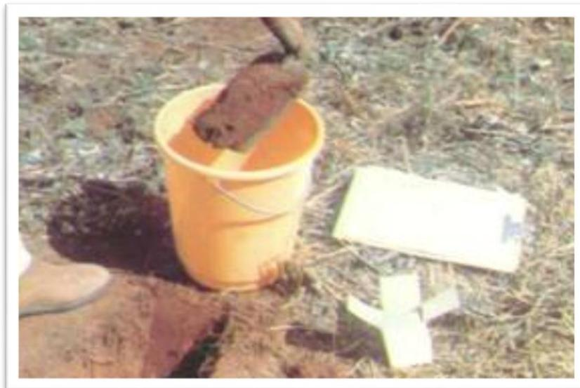
Figura 2.31: Exemplo de amostra de solo deformado
