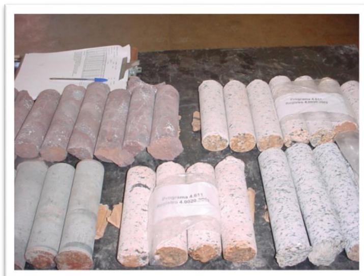
Figura 2.33: Exemplo de amostra de rocha
