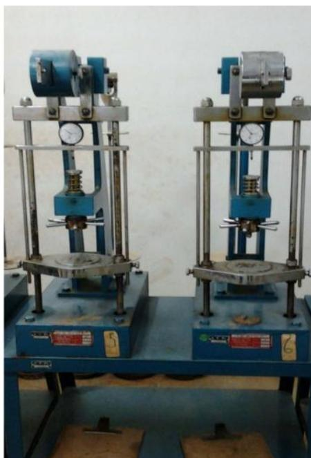
Figura 4.19: Prensas de adensamento.
