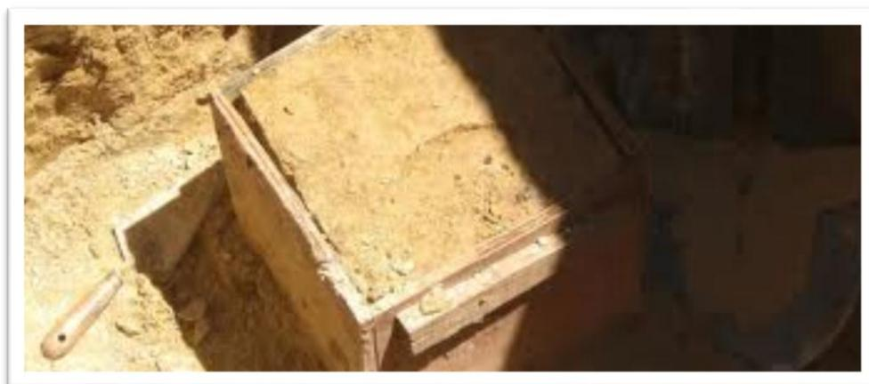
Figura 2.32: Exemplo de amostra de solo indeformado
