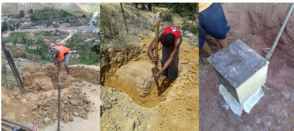
Figura 4.17: Fotos da retirada das amostras indeformadas.
