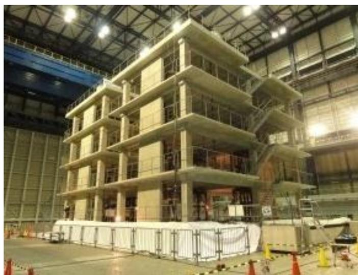
Figura 2.29. Protótipo de um edifício de 4 pavimentos no Laboratório E-Defense (<http://peer.berkeley.edu/events/2013/nees-edefense>)
