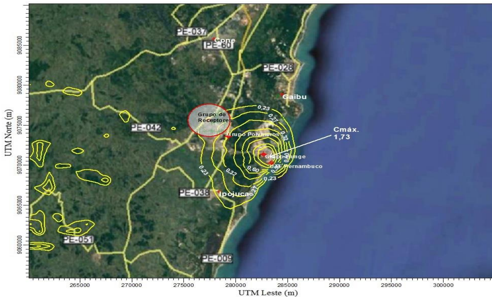
FIGURA 38 – Mapa das isoconcentrações de CO, média de 8 horas, concentração máxima obtida de 1,73 \mu\text{g.m}^{-3} Padrão primário da qualidade do ar para CO, média de 8 horas, igual a 10.000 \mu\text{g.m}^{-3} - Resolução CONAMA N° 03/1990
