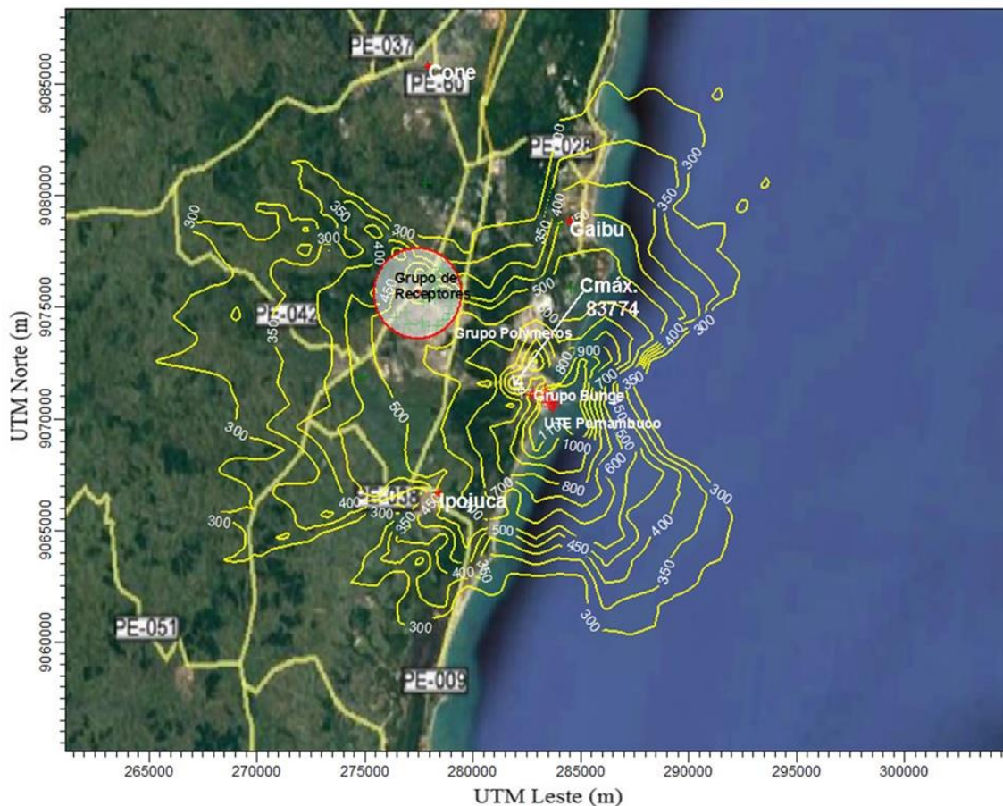
FIGURA 39 – Mapa das isoconcentrações de COV (média de 1 hora). Concentração máxima obtida de 83.774 \mu\text{m}^{-3} .
