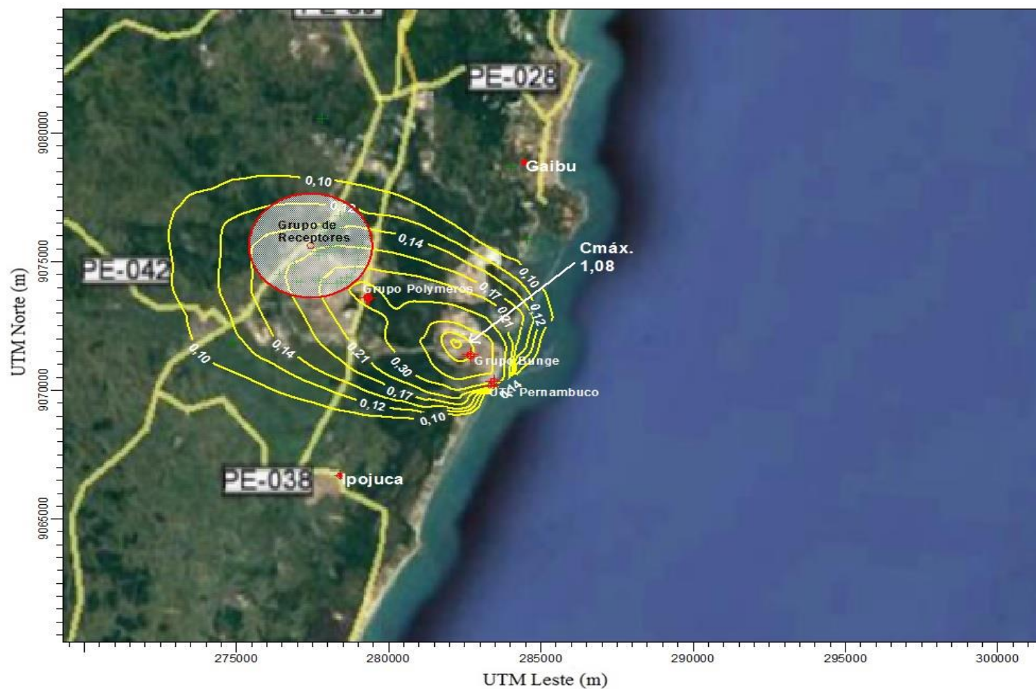
FIGURA 39 – Mapa das isoconcentrações de \text{NO}_2 , média de anual, concentração máxima obtida de 1,08 \mu\text{g.m}^{-3} . Padrão primário da qualidade do ar para \text{NO}_2 , média anual, igual a 100 \mu\text{g.m}^{-3} - Resolução CONAMA N°03/1990.
