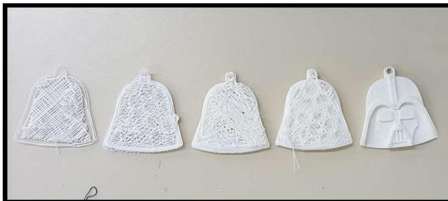
**Figura 20:** Diversas tentativas de impressão para conseguir o resultado esperado (modelo à direita). (Fonte: elaborada pelo autor<sup>22</sup>).
