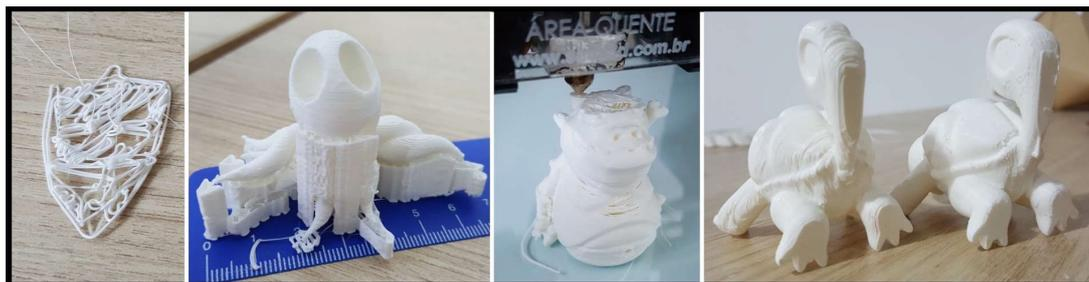
**Figura 32:** Algumas falhas no processo de impressão 3D durante a atividade 2. (Fonte: elaborada pelo autor).
