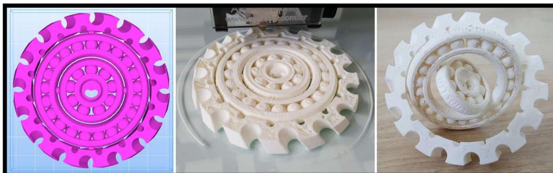
**Figura 16:** Peça composta por partes móveis e impressa toda montada. (Fonte: produzida pelo autor<sup>12</sup>).
