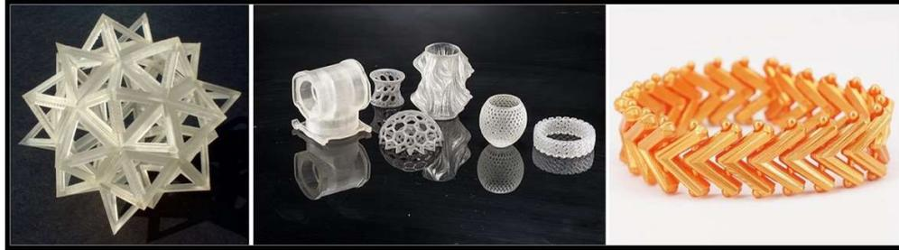
**Figura 6:** Exemplos de modelos impressos em SLA. (Fonte: georgehart.com; 3ders.org; all3dp.com).
