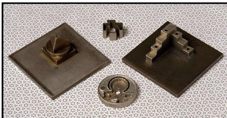
**Figura 11:** Peças produzidas pelo processo de LENS. (Fonte: sandia.gov).
