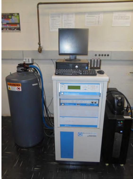
Figura 3.3 – PPMS (Physical Properties Measurement System) - Equipamento utilizado para a realização de medidas de transporte.
