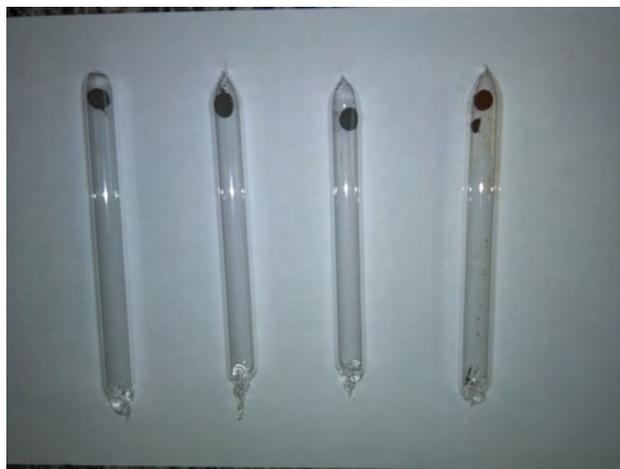
Figura 5.1 – Pastilhas seladas em um tubos de borossilicato sob vácuo.
