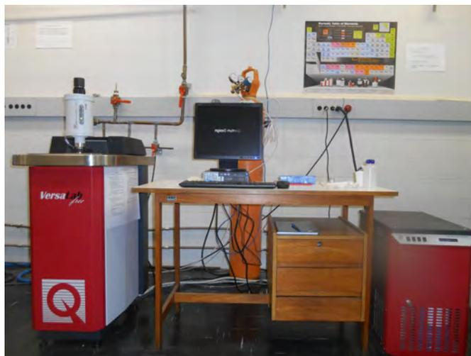
Figura 3.4 – Versalab - Equipamento utilizado para a realização de medidas magnéticas.
