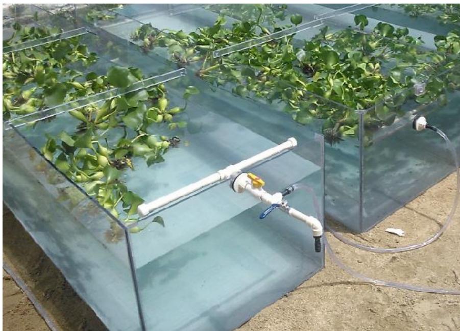
Figura 8 - Protótipos do wetland construído preenchidos por macrófitas
