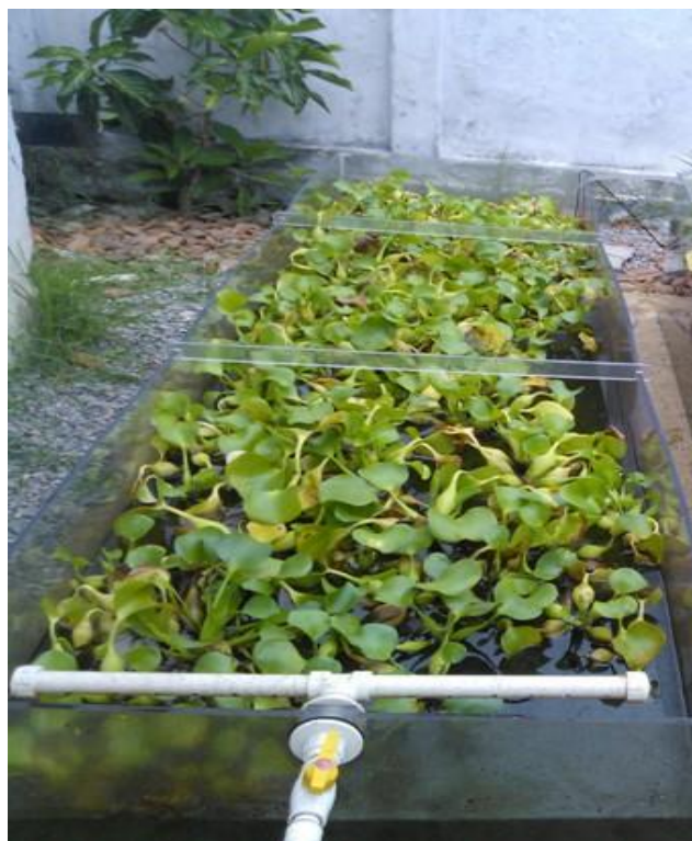
Figura 9 - Protótipo preenchido com efluente oleoso
