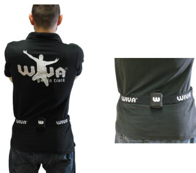
Figura 4: Posicionamento do sensor inercial Wiva® Science sensor na altura da vértebra L5
