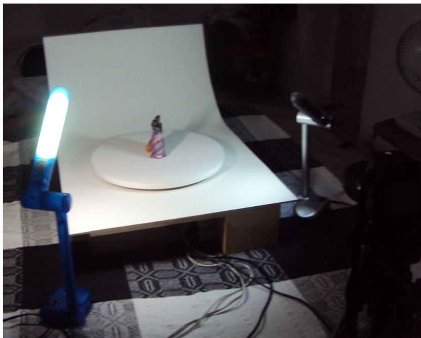
**Figura 46 – Protótipo funcional da Mesa Digitalizadora**
