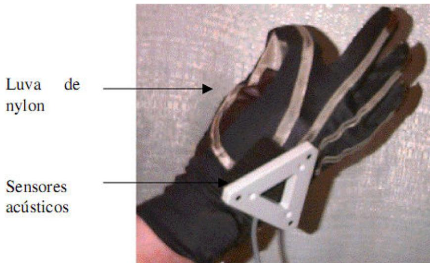
Figura 4 – Luva digital com rastreamento acústico
