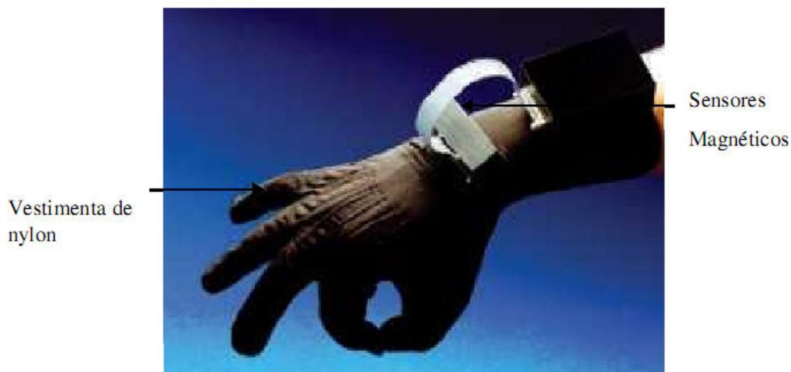
Figura 5 – Luva de dados com sensores magnéticos
