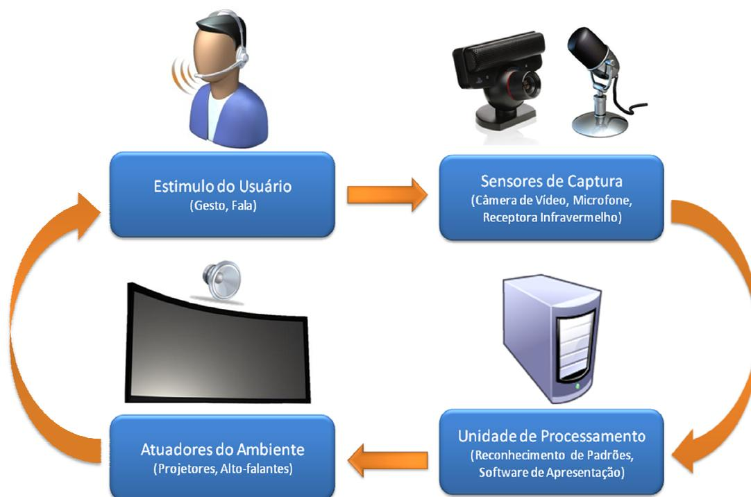
**Figura 31 – Pipeline do processo de comunicação multimodal**
