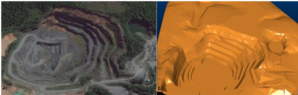
Figura 23 - Vistas atuais do local de transporte de lavra. a) real sem desenvolvimento. b) modelado com desenvolvimento do nível -60 m.
