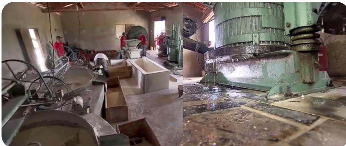
Figura 3 - Processamento da mandioca com obtenção de farinha e manipueira
