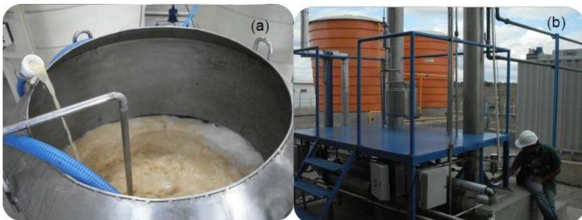
Figura 12 - Equipamentos de fermentação (a) e destilação (b) da usina de Lajedo/PE.
