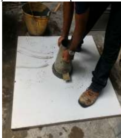
Figura 17 (4): determinação da consistência pelo método do tronco-de-cone.
