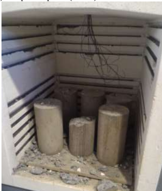
Figura 28 (5): Corpos-de-prova (15x30)cm submetidos à 600°C.
