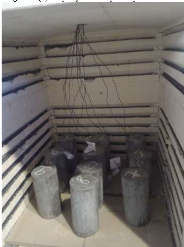
Figura 11 (4): Disposição dos corpos-de-prova no forno.
