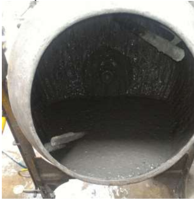
Figura 15 (4): Início do processo de mistura dos materiais constituintes do concreto.
