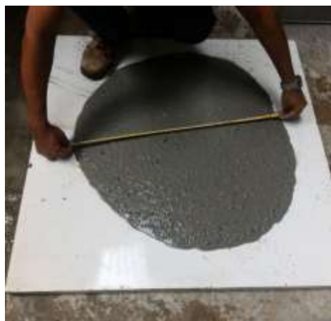
Figura 19 (4): Determinação do espalhamento.
