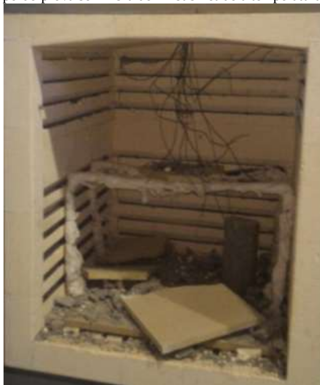
Figura 57 (5): Corpo-de-prova sem fibra de PP submetido à temperatura de 400°C.
