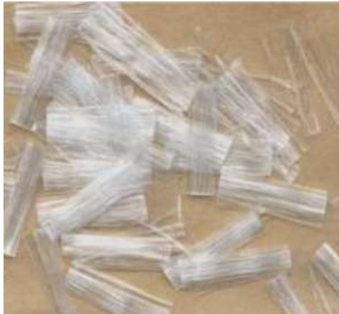
Figura 5 (3): Fibras de polipropileno do tipo fibrilado.
