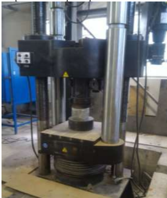
Figura 10 (4): Ensaio de compressão no corpo-de-prova cúbico executado no Laboratório.
