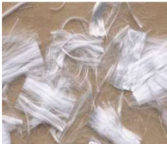
Figura 6 (3): Fibras de polipropileno monofilamento.
