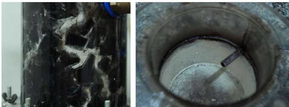
Figura 5.21 – Precipitação de enxofre no meio suporte da zona microaerada (esquerda) e aderido às paredes acima do nível d'água (direita).
