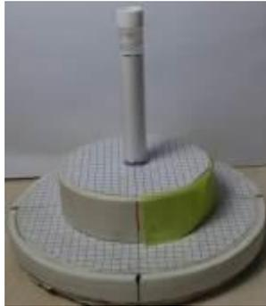
(a) tubo de ensaio com material para leitura,  $h_1$ .
