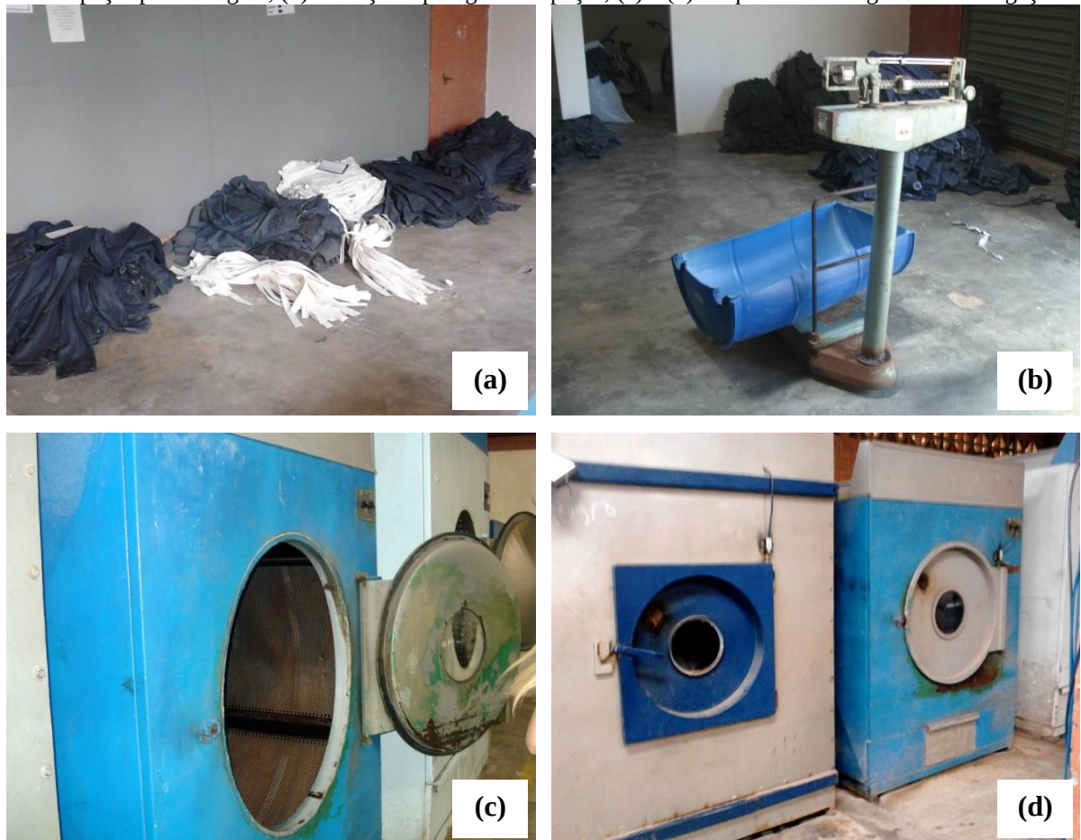
Figura 2 – Imagens ilustrativas de uma lavanderia de porte médio do localizada no APLCP: (a) Recebimento das peças para lavagem; (b) balança de pesagem das peças; (c) e (d) máquinas de lavagem e centrifugação
