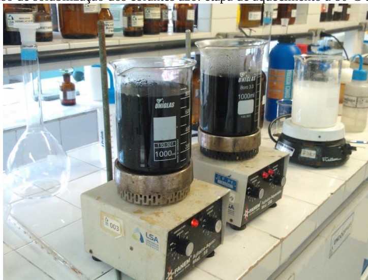
Figura 14 – Processo de solubilização dos corantes azo: etapa de aquecimento a 80°C em chapa aquecedora
