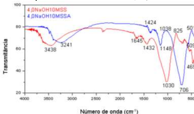
Gráfico 26 - Espectro do FTIR \text{SiO}_2/\text{Al}_2\text{O}_3=4,0 - 10 M - SS e SSA
