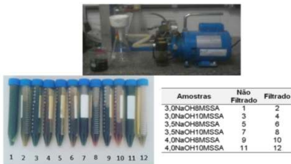
Foto 6 - a) Sistema de filtração, b) Amostras filtradas e Não Filtradas e c) Legenda das Amostras.
