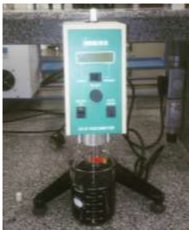
Foto 5 - Viscosímetro digital utilizado para as medidas dos SSA
